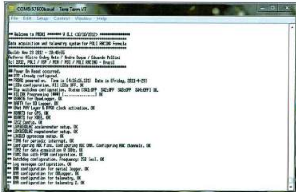
Figura 71: Janela de terminal com os comandos de diagnose enviados pelo PRDA1 na inicialização do hardware
