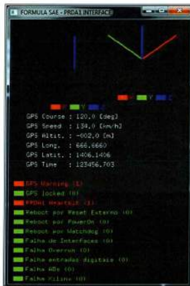
Figura 76: Janela de Status do PRDA1 e visualização 3D das acelerações
