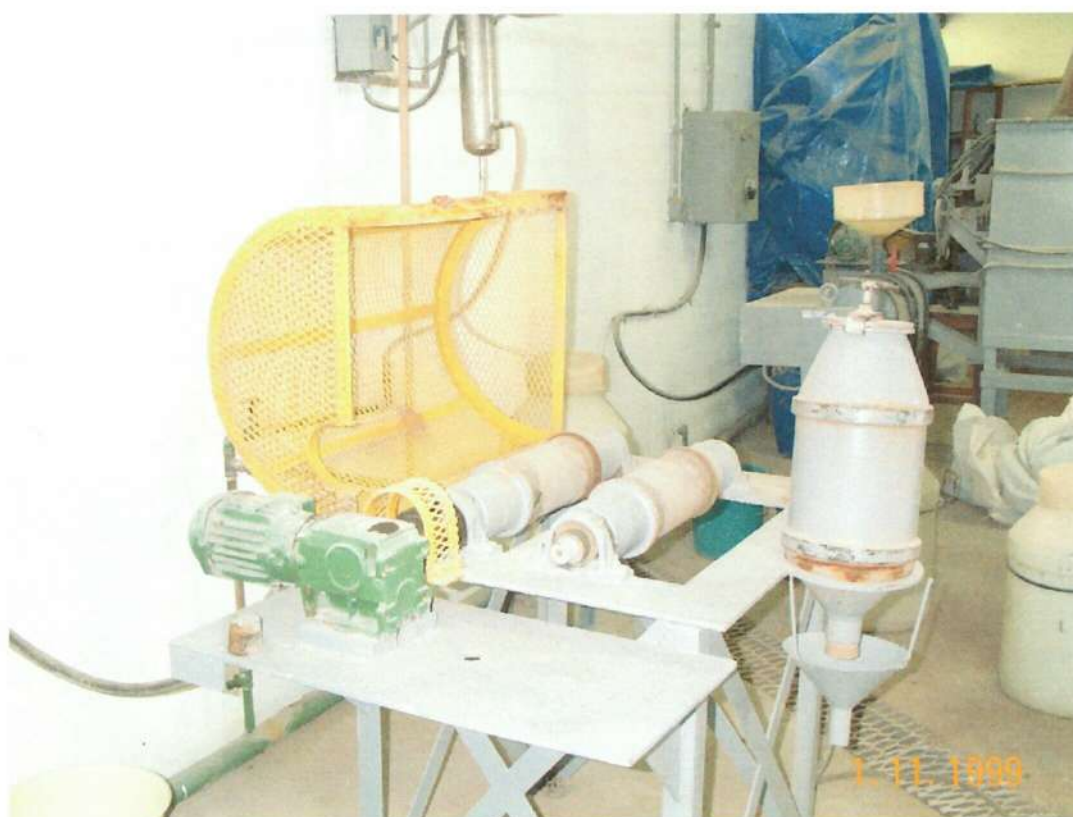
FOTO 17: Moinho de rolos (operação via úmida, utilizando carga de bolas).
