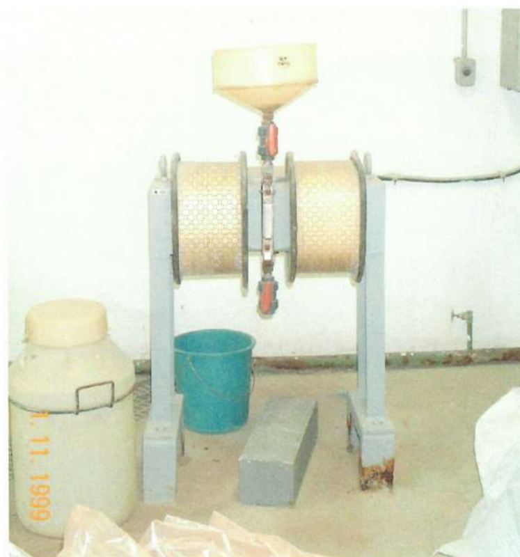
FOTO 18: Equipamento de separação magnética do tipo WHIMS (Wet High Intensity Magnetic Separator).
