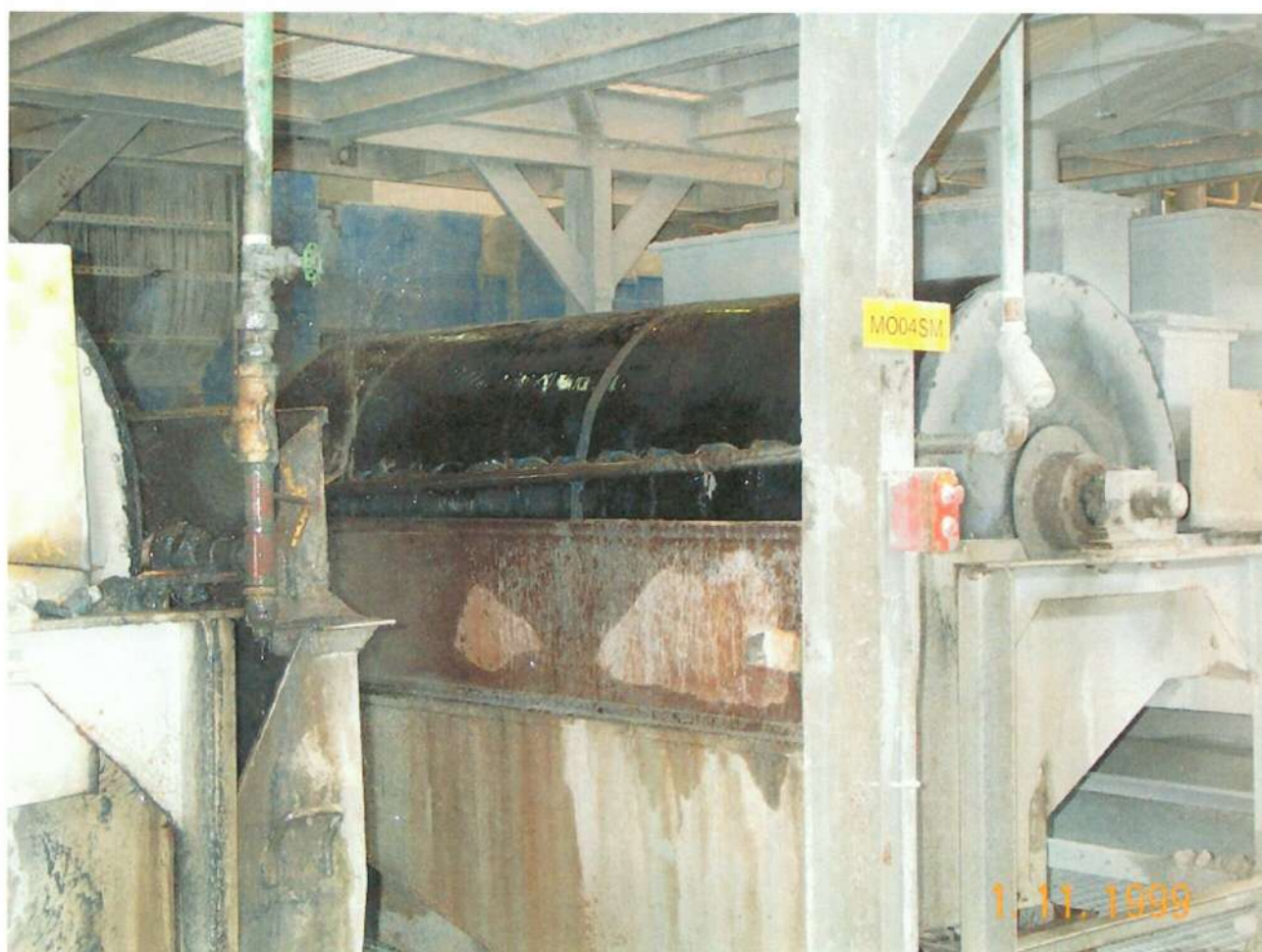
FOTO 5: Separação da magnetita na usina através de polia magnética.
