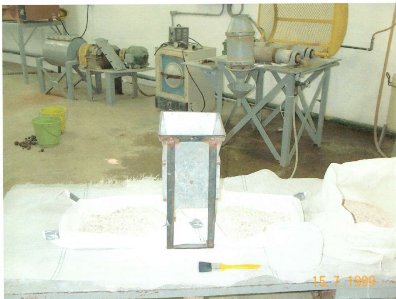
FOTO 15: Quarteamento da amostra britada utilizando quarteador do tipo Jones .
