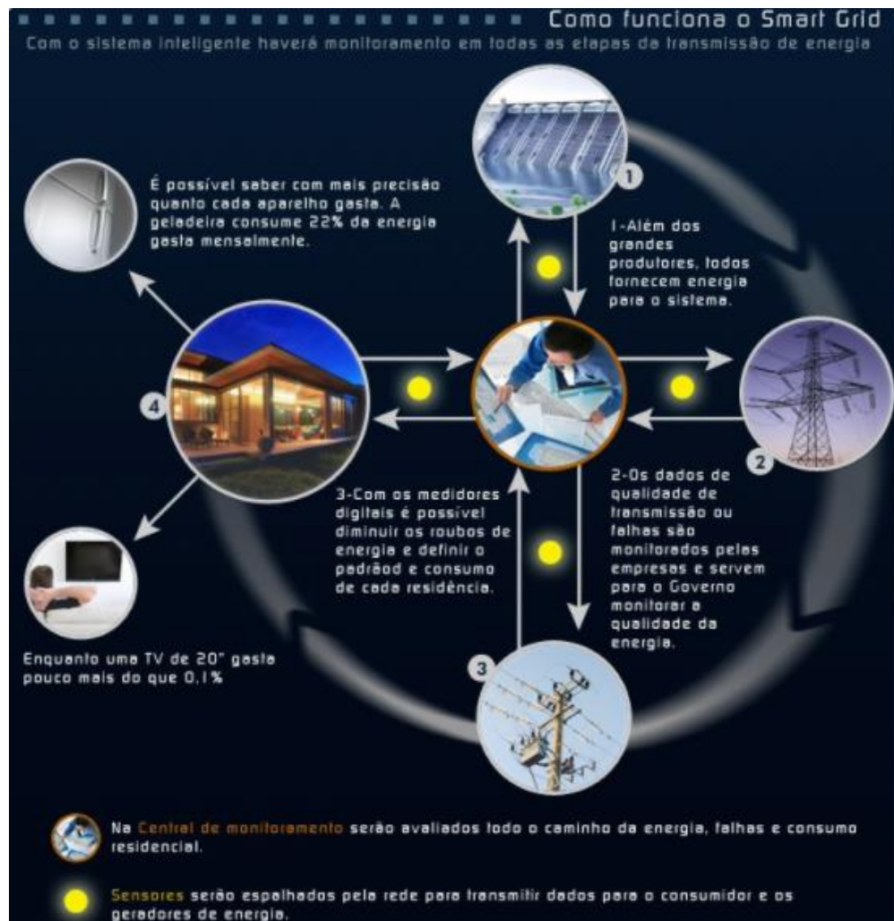
Figura 16 – Resumo: funcionamento das redes inteligentes (SG) e integração com GD
