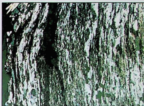
Figura 15 – (a) Detalhe do sericita quartzo xisto. Aparente sujeira na seção é a grafita. Em 0,5 mm (b), sericita quartzo xisto em polarizadores cruzados, mostrando a textura granolepidoblástica.
