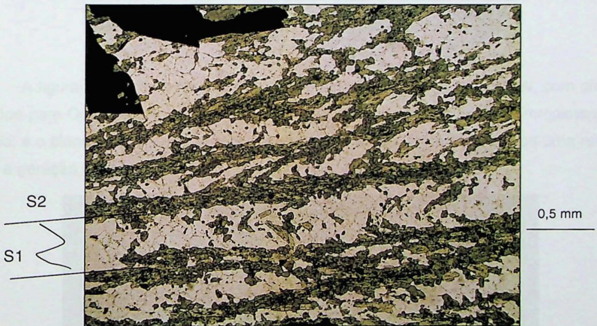
Figura 22 – Foliação S_1 e S_2 , C e S, respectivamente, a foliação encontrada em turmalinitos bandados.
