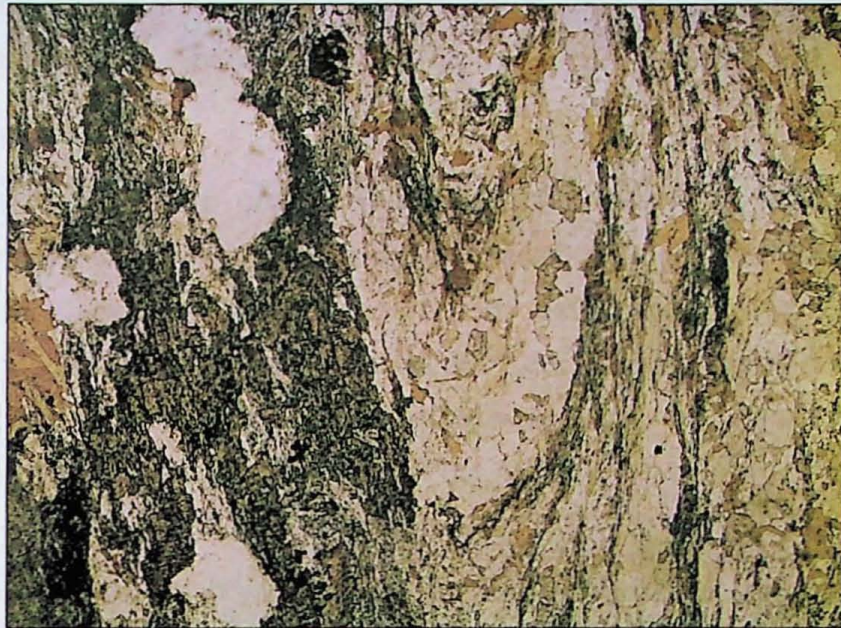
Figura 25 – Dobra fechada de quartzo-carbonato em xisto sericítico.
