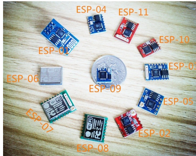
Figura 3.3: Diferentes modelos da família ESP8266 disponíveis no mercado [7]
