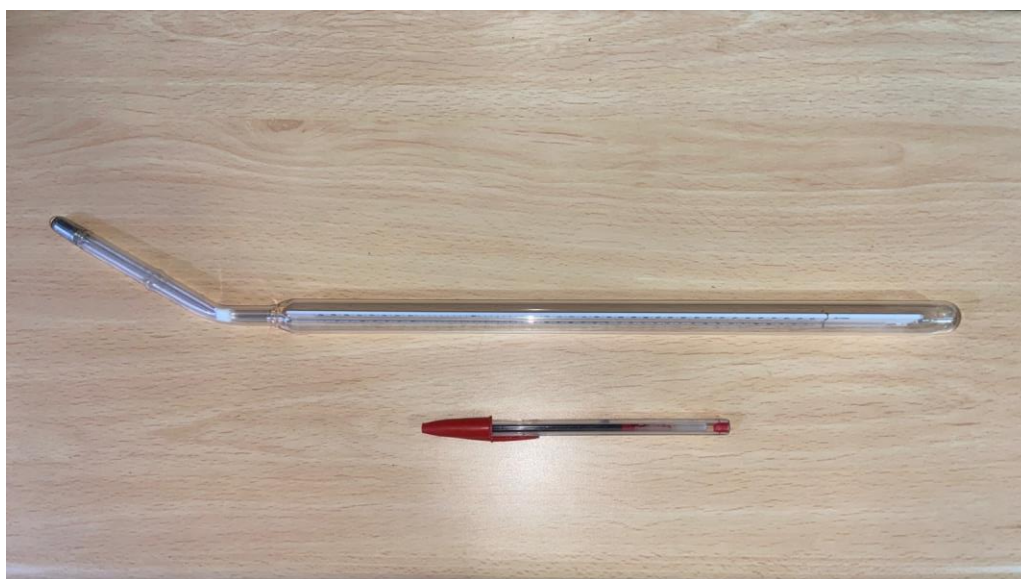
Figura 8 - Geotermômetro ou termômetro de solo
