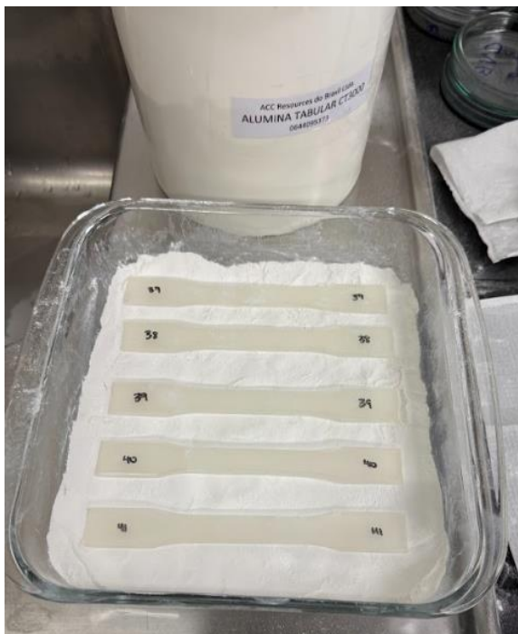
Figura 16: Compactação das amostras em alumina para recozimento
