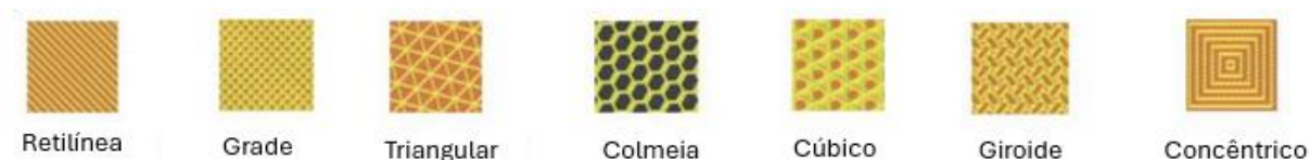
Figura 9: Alguns padrões de preenchimento em FDM
