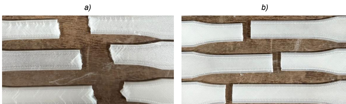
Figura 41: Fotografias das amostras fraturadas a) V70T200; b) V70T220
