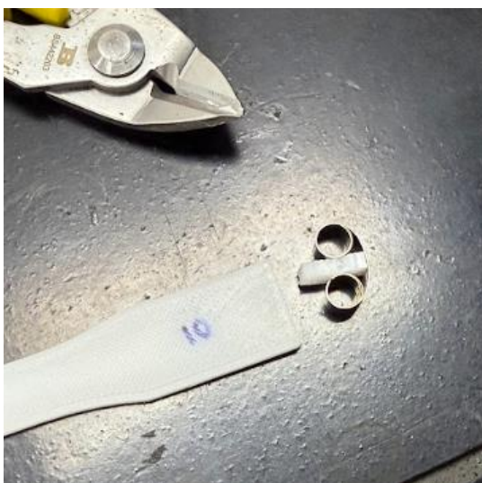
Figura 18: Corte realizado para análise de fratura
