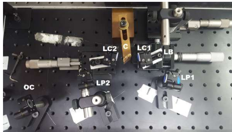
Figura 13: Cavidade do laser com Ti:Safira femtossegundo com as respectivas legendas.
