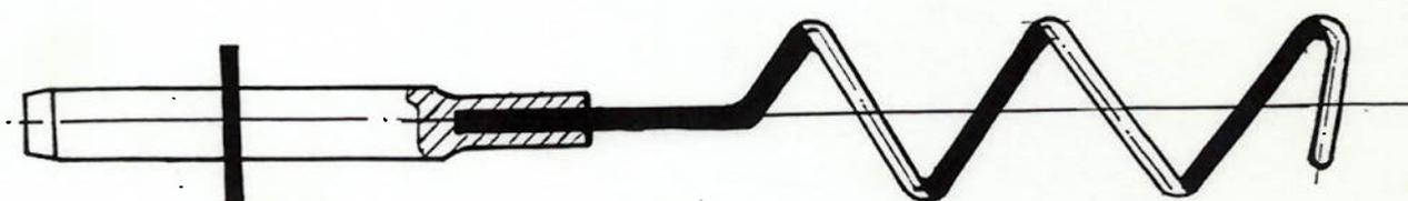
Figura 3b: Misturador de Massa Pesada para Batedeira de Bolo. Transcrito de material do Desenvolvimento da empresa.
