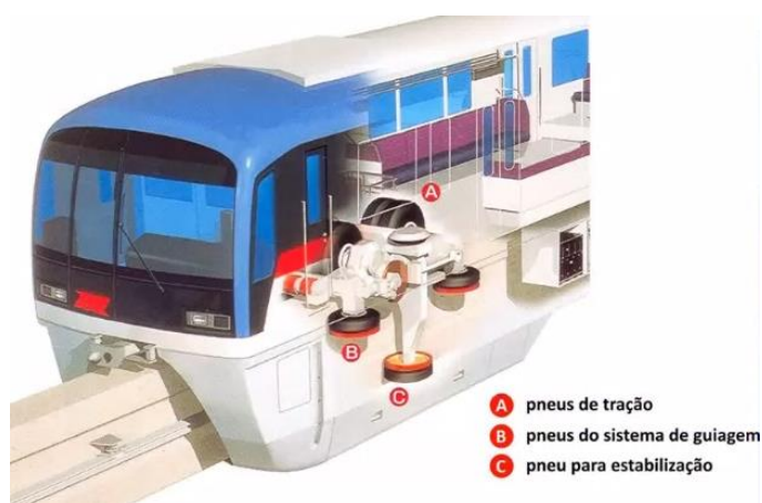
Figura 2 - Configuração típica de trilho e sistema de apoio/propulsão
