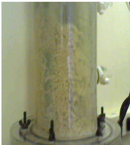
Figura 5.8 – Detalhe da biomassa e polímeros extracelulares acumulados no leito do reator.
