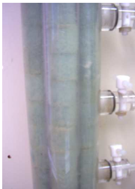
Figura 4.6 – Detalhe do leito ordenado de espumas.
