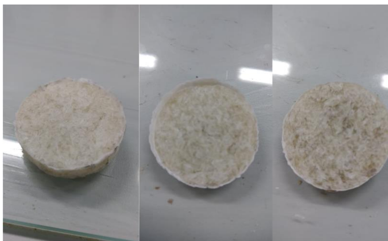
Figura 20: Amostras de TPS com teor de argila variável. (Da esquerda para direita: A 2% , A 5% , A 10% )
