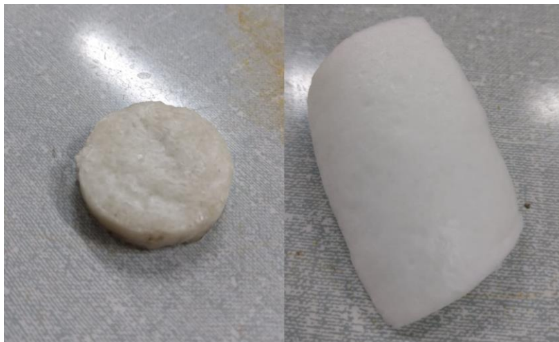
Figura 23: Parafina como revestimento nas amostras de TPS
