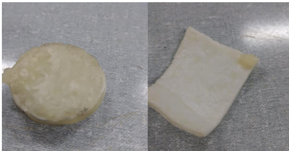
Figura 24: Cera de Abelha como revestimento nas amostras de TPS
