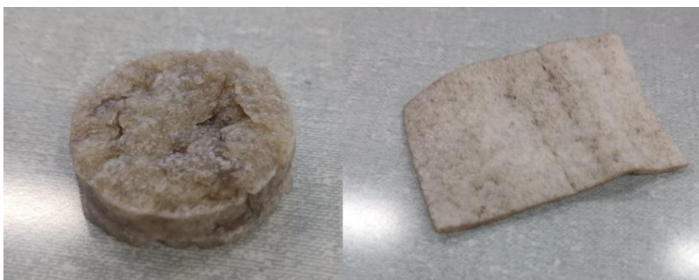
Figura 27: Silicone como revestimento nas amostras de TPS
