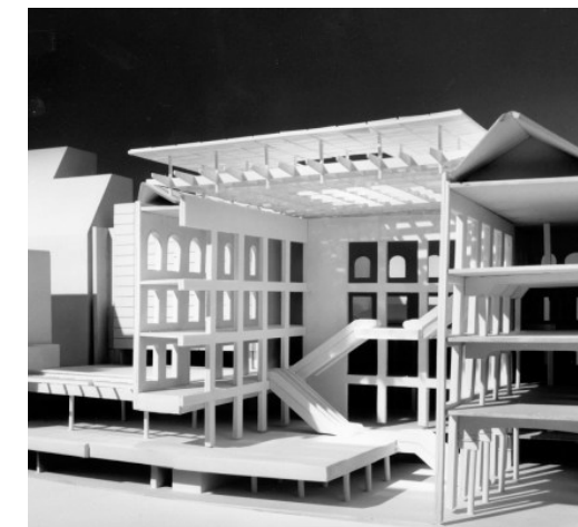
IMAGEM 35. Maquete eletrônica do projeto para o Centro Cultural dos Correios. A praça interna que deveria se conectar com o Beco do Piolin, com empena destinada a projeções e cinema ao ar livre não foi construída. [UNA Arquitetos]
