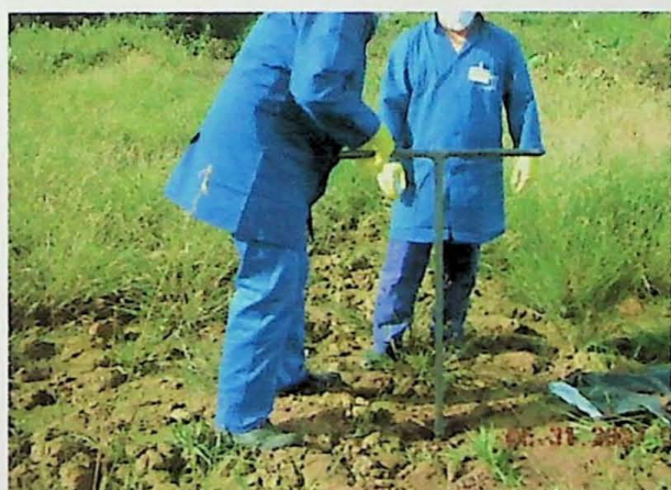
Figura 7 – Amostragem por trado manual.
