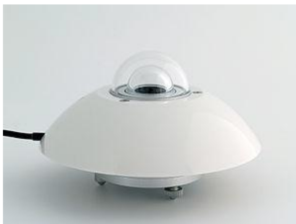
Figura 46- Pirânometro cedido pelo PECE –USP professor Cláudio Pacheco
