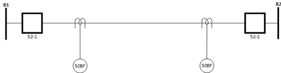
Figura 24 – Polarização da proteção de falha disjuntor
