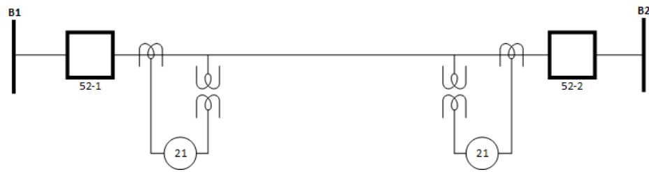
Figura 6 – Entradas Analógicas da função de distância
