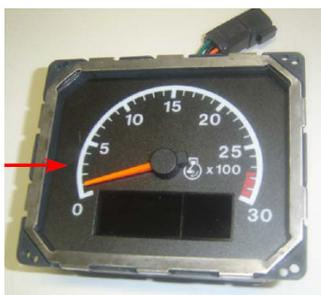
**Figura 2.17:** Módulo de indicadores de alerta e velocidade/tacômetro.
