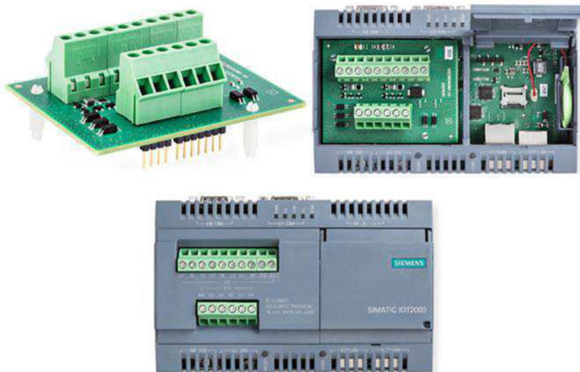
Figura 12 - Shield que pode ser adicionado ao SIOMATIC IOT2000. No canto superior esquerdo, foto do Shield apenas. No canto superior direito, pode-se observar a montagem do Shield na placa do gateway. Já a imagem inferior mostra o gateway fechado, com o Shield.
