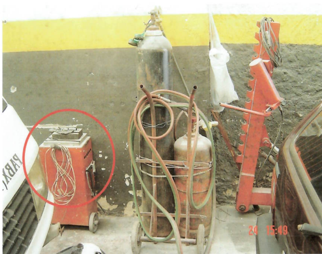
Foto 8 – Conjunto oxiacetilênico próximo a um carregador de baterias.
