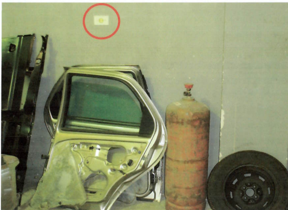
Foto 4 – Cilindro de acetileno próximo a uma tomada comum.
