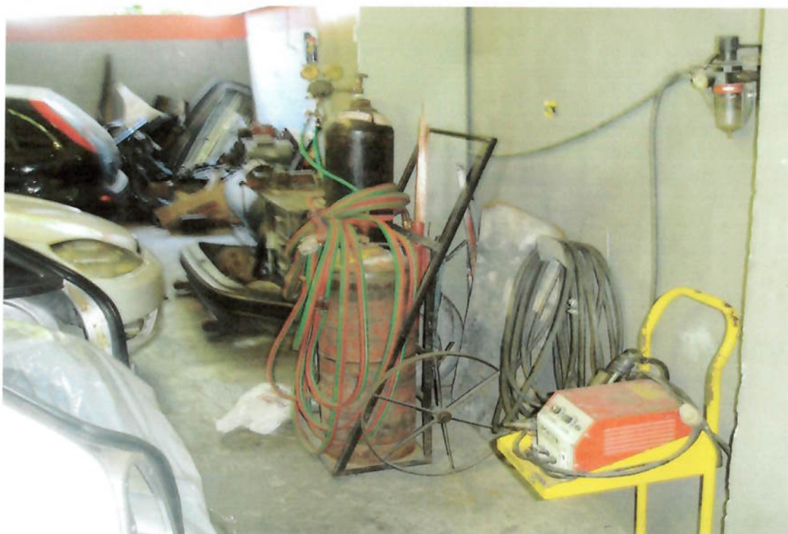
Foto 2 – Conjunto oxiacetilênico próximo a um carregador de baterias.
