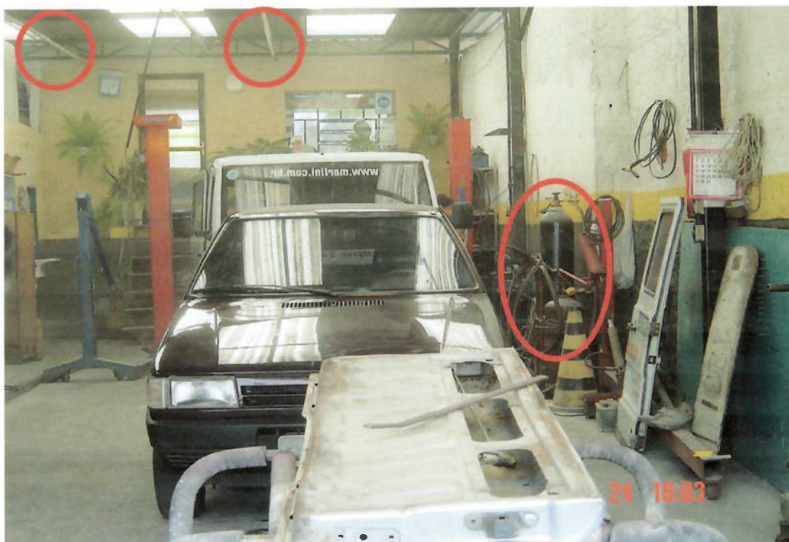
Foto 9 – Lâmpadas comuns próximas ao conjunto oxiacetilênico.
