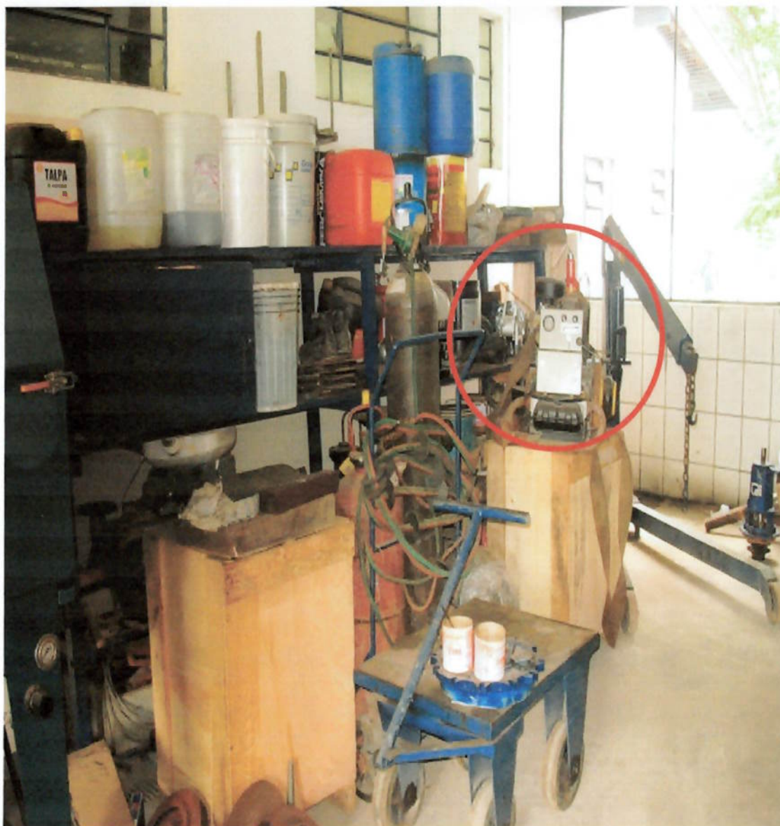
Foto 5 – Conjunto oxiacetilênico próximo a produtos inflamáveis.
