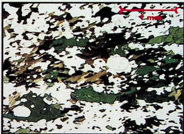
Foto 21 - Par S-C de foliação (lâmina STX14- polarizadores descruzados)
