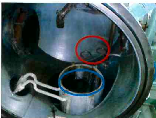
Figura 7: Suporte para amostradores (vermelho) e casca de zirconita (azul).
