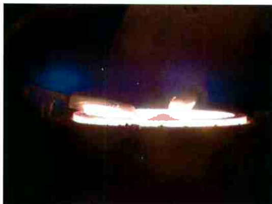
Figura 9: Vista lateral do banho de 500g Si fundido a 1750°C
