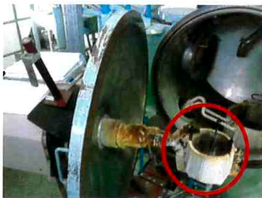
Figura 6: Bobina usada para fundir e manter o aquecimento do silício (vermelho) e sua alavanca para basculamento.
