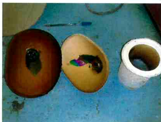
Figura 10: Amostras do ensaio de 500g Si tratado sob vácuo a 1750°C
