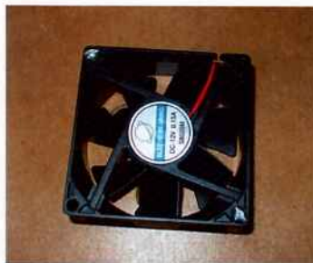
Figura 41 – Cooler usado como ventilador
