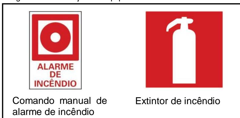
Figura 8 – Sinalização de Equipamentos de Combate a incêndio.
