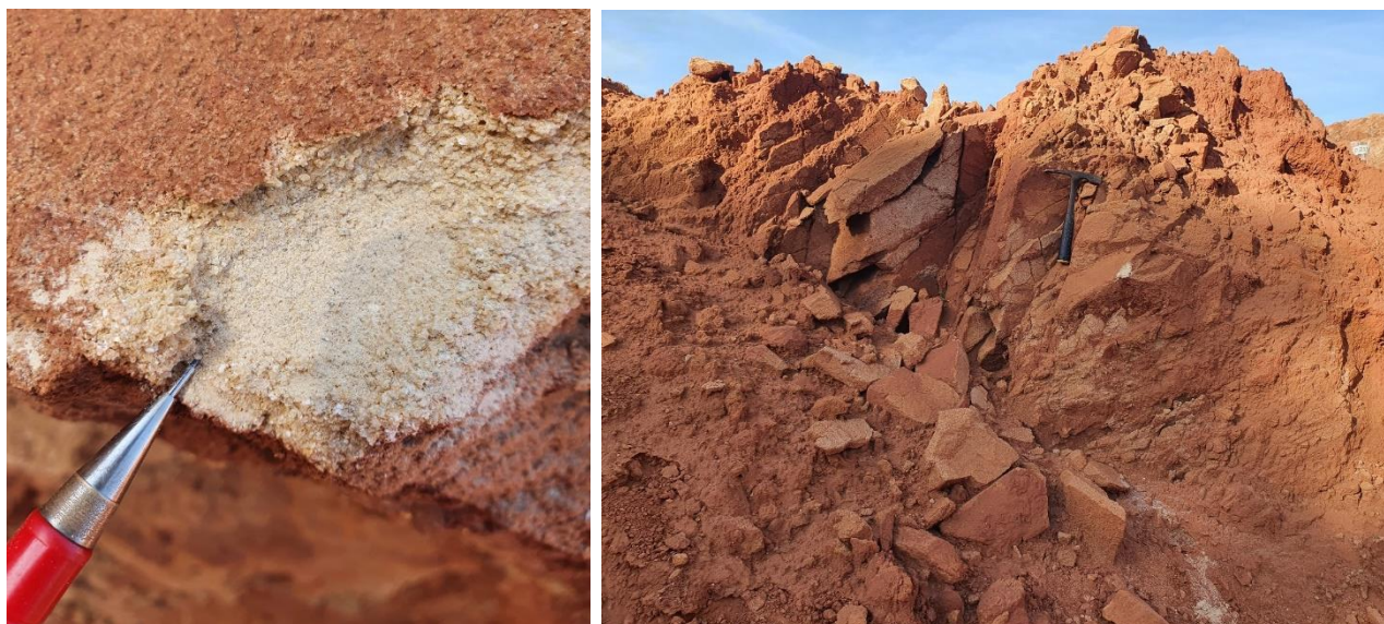
Figura 6.17 - A esquerda temos detalhe do arenito encontrado na Jazida da Fazenda ressaca, e a direita as camadas em que o arenito se encontra, já em processo de intemperismo e desagregando
