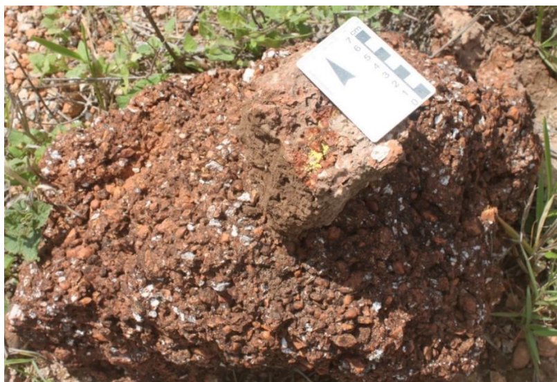
Figura 6.2 - Detalhe do material do litotipo Rocha Fosfática Bege Friável com os nódulos de material fosfático.
