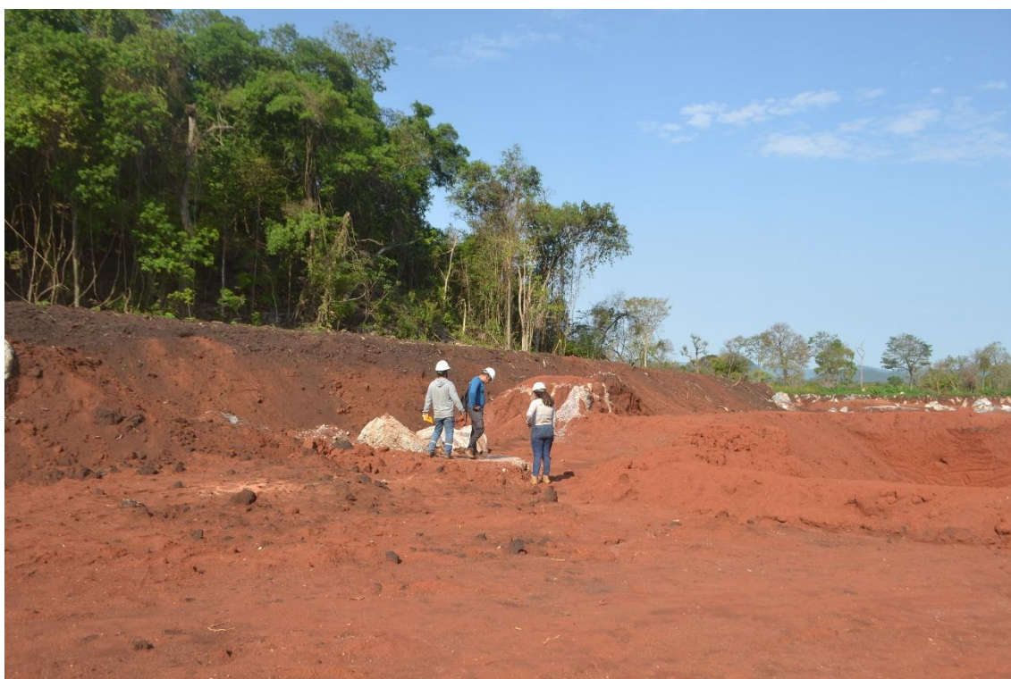
Figura 6.5 - Nova área com início de lavra do litotipo Rocha Fosfática Bege Friável, onde o topo de um pináculo (com as pessoas em cima), cortado com fio diamantado, para facilitar a lavra (detalhe na figura 6.6).
