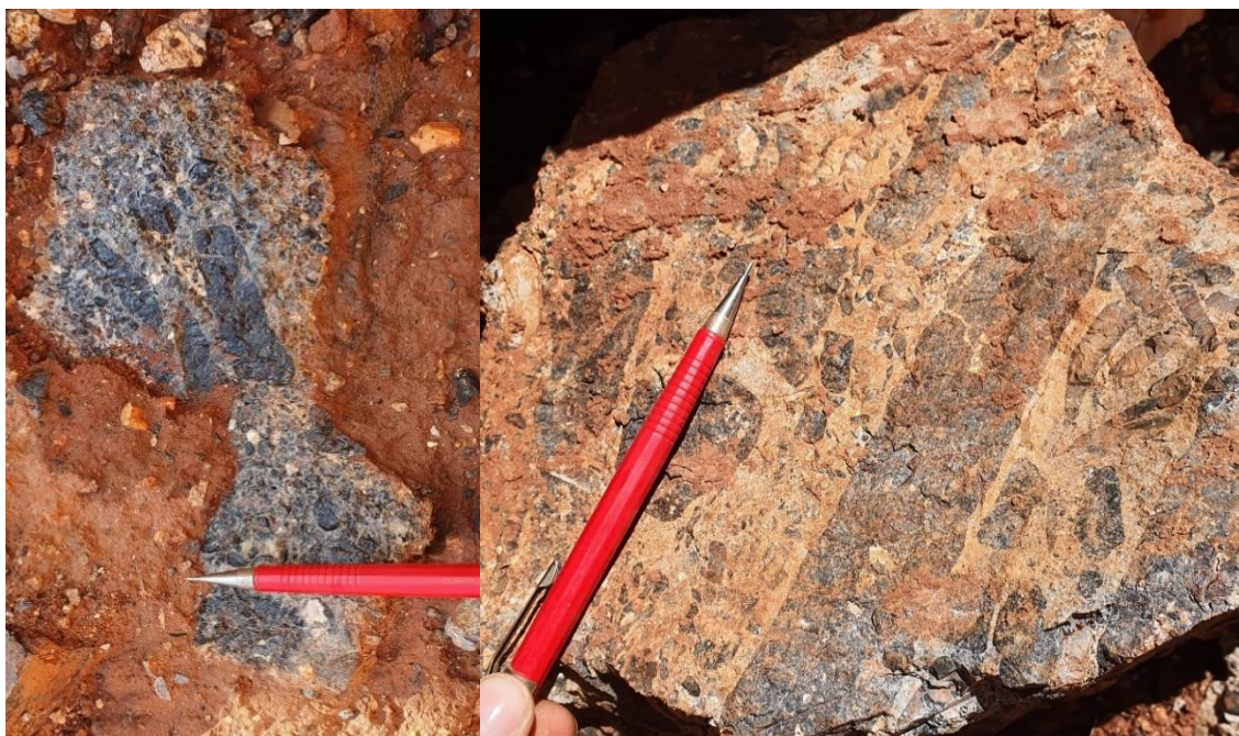
Figura 6.18 - A esquerda temos a brecha com fragmentos de fosforito subarredondados a angulosos, de milimétricos a centimétricos, e a direita temos os clastos com deformações onduladas
