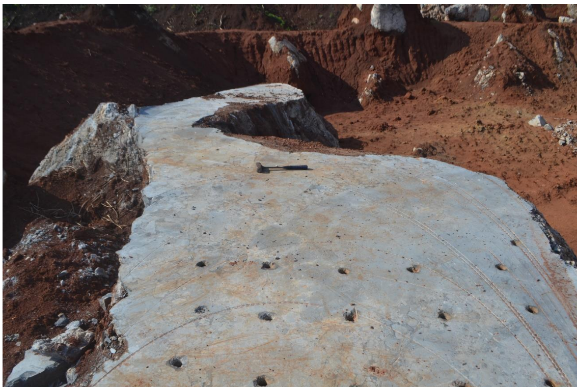
Figura 6.6 - Topo do pináculo cortado com fio diamantado e perfurado com martelete para uso de massa expansiva para fragmentação, como forma de facilitar a lavra do litotipo friável.
