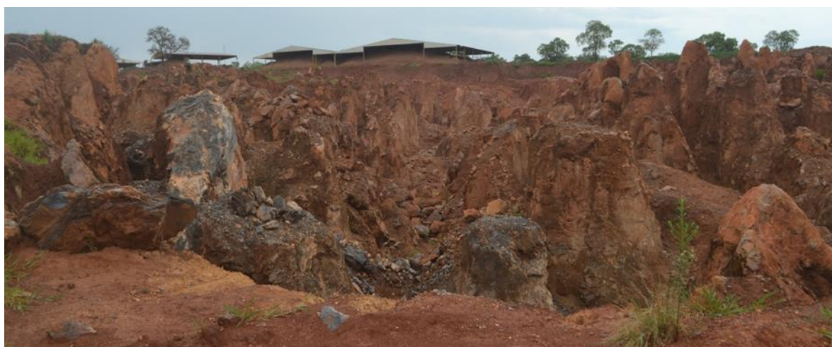
Figura 6.3 - Área lavrada do material friável (mesma área apresentada na figura 6.1) com os pináculos cársticos dos litotipos primários, demonstrando ser uma lavra difícil em função da geometria irregular da porção inferior do corpo. Ao fundo o telhado do depósito do material lavrado.
