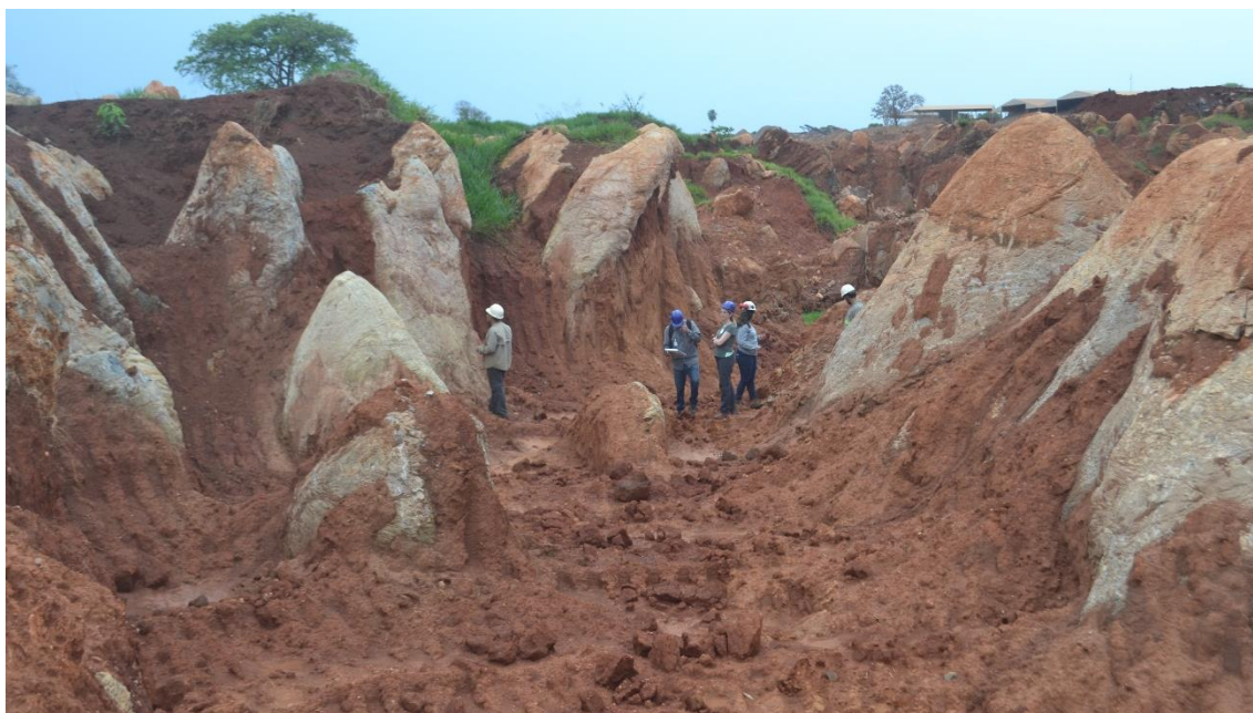
Figura 6.4 - Detalhe do topo dos pináculos em processo de escavação do litotipo Rocha Fosfática Bege Friável, este que é encontrado recobrindo e entre os canais formados entre os pináculos, dificultando acesso de escavadeiras.
