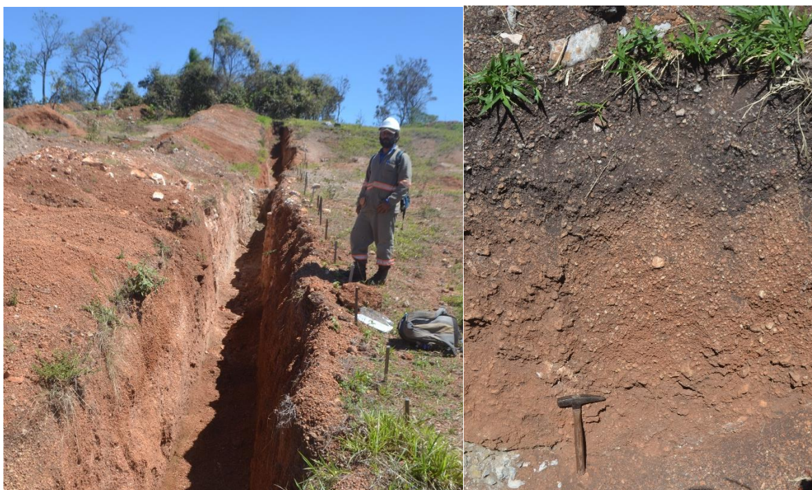
Figura 6.11 - Trincheira (Trincheira 4) escavada na porção superficial da Jazida, com exposição da Rocha Fosfática Bege Friável da Jazida da Fazenda Ressaca, local onde foi realizada a canaleta vertical para coleta de amostras para análises químicas.
