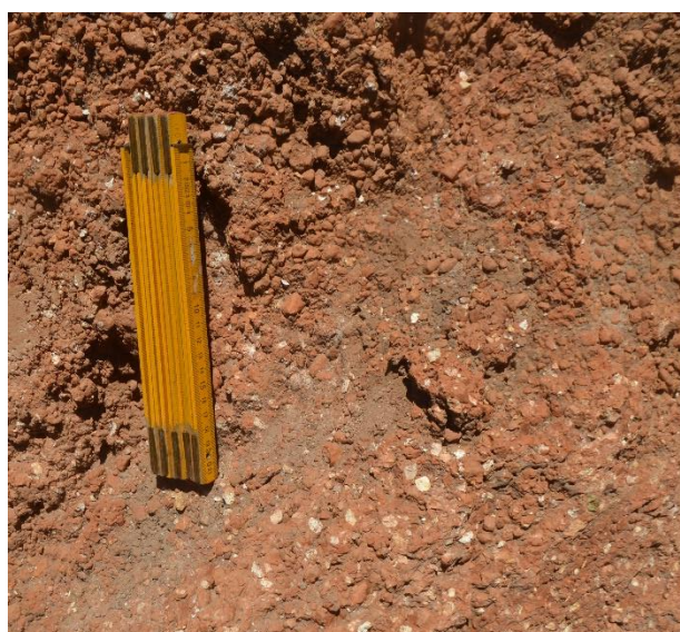
Figura 6.8 - Detalhe da Trinchira 10 (49 m), que possui 0,2 m de profundidade, com exposição do litotipo Rocha Fosfática Bege Friável.
