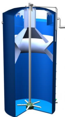
Figura 10 – Reator Anaeróbio de Fluxo Ascendente e manta de lodo (UASB)
