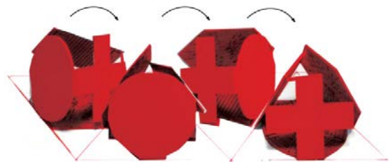
27 Diagrama de movimentação do Prada Transformer: quatro faces conformando quatro funcionalidades distintas
