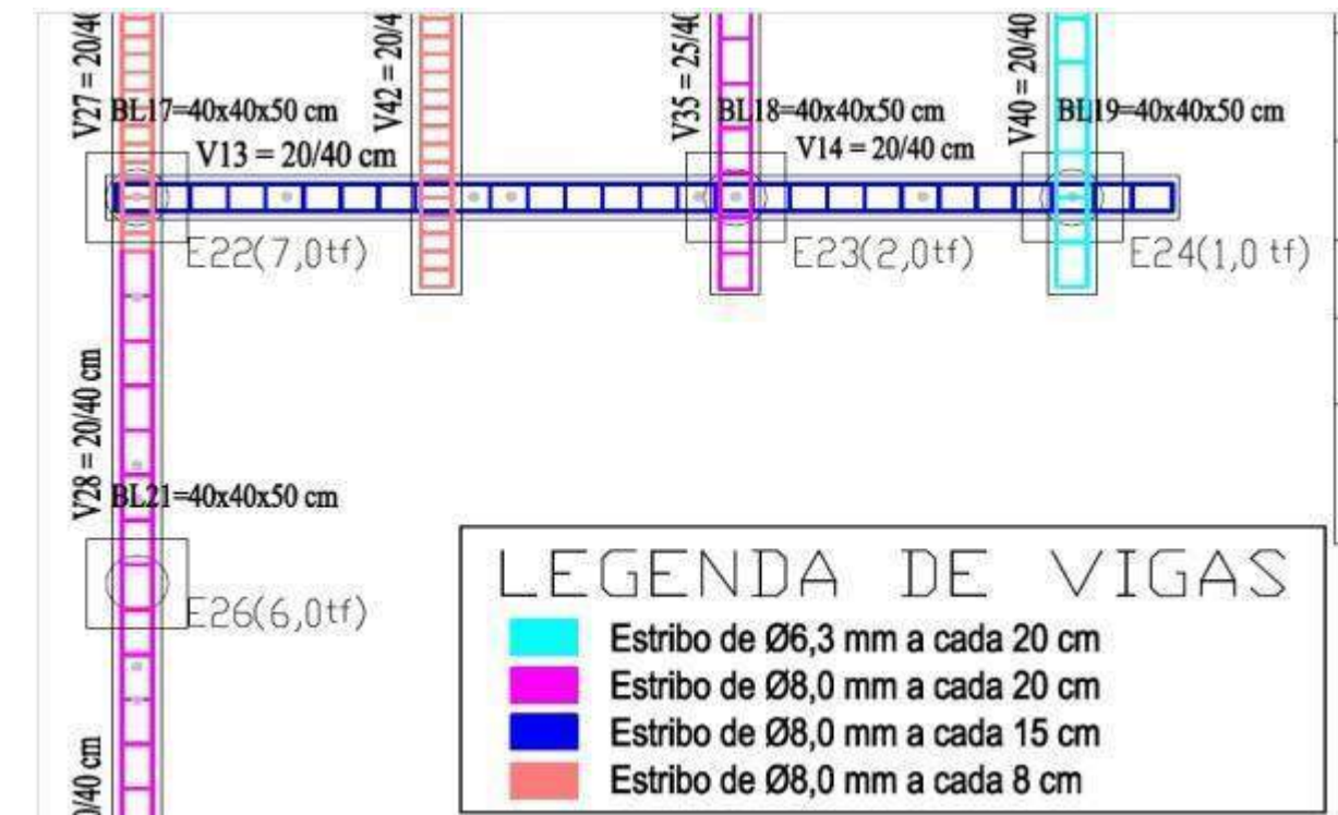
Figura 26 – Projeto de Produção de Fundações – Folha 07/10
