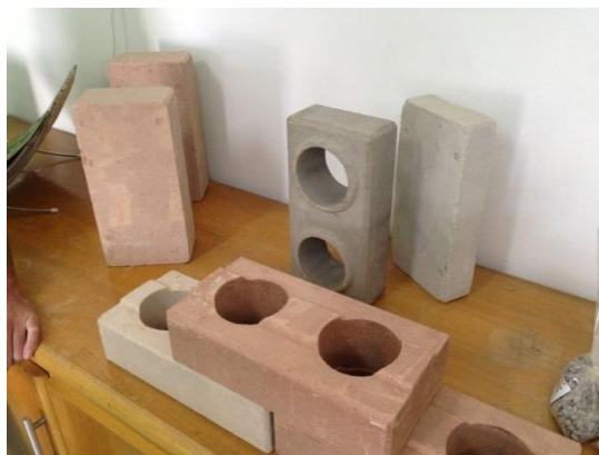
Figura 4-11 Fabricação de peças pré-moldadas a partir da areia proveniente de materiais reciclados.
