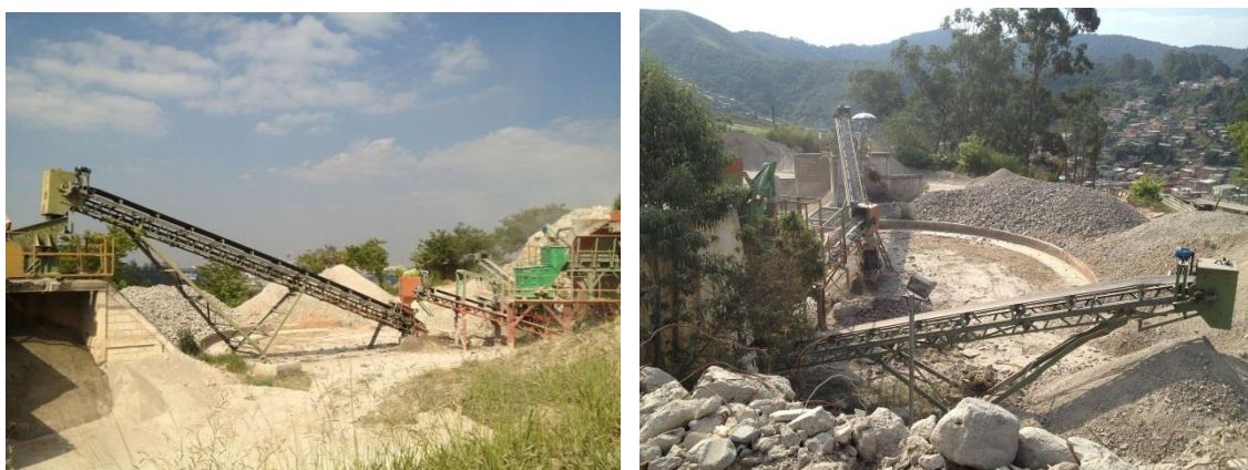
Figura 4-9 Transportadora de correia fixa, empregada para transporte de material britado (bica corrida)
