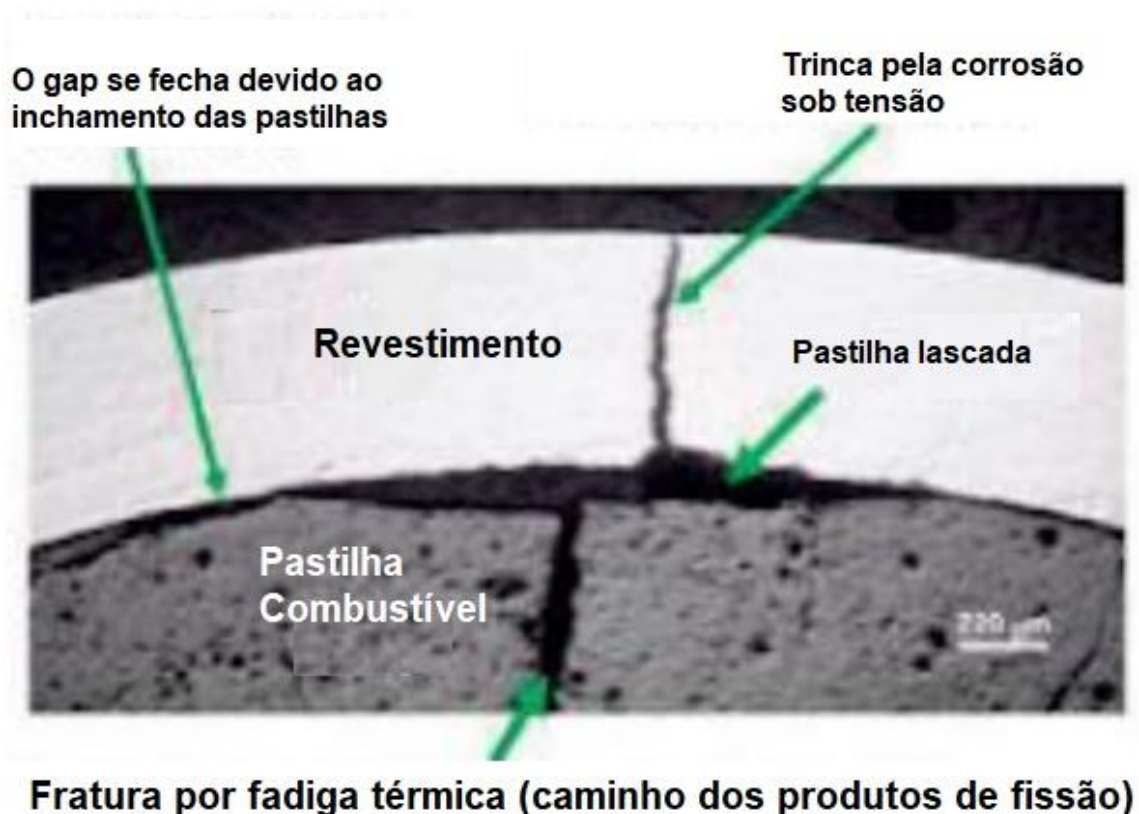
Figura 5 - Micrografia de um caso real de PCI-SCC, em que é possível ver as trincas na pastilha e no revestimento (Adaptado - Whittle, 2016).
