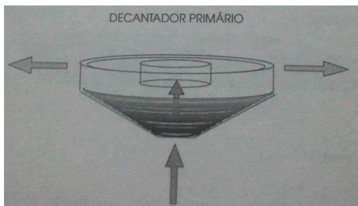
Figura 8: Esquema de um decantador primário circular.
