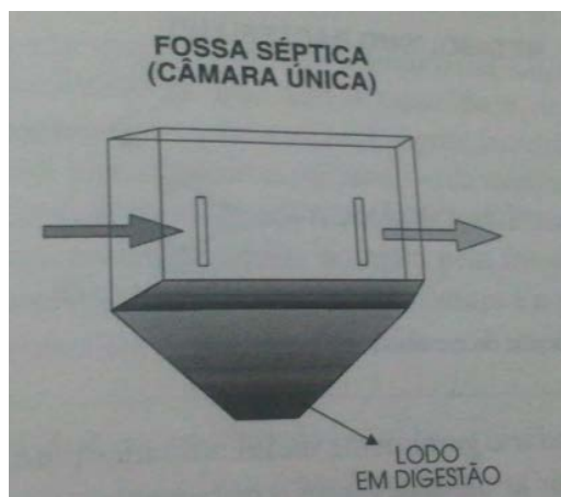
Figura 9: Esquema de uma fossa séptica de câmara única.
