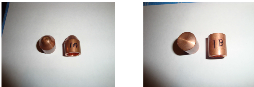
Figura 18 - Eletrodo tipo plano cone truncado (esq.) e esférico (dir.)
