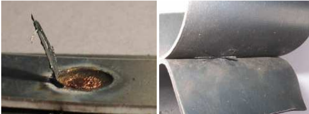
Figura 6 - Expulsão de material na superfície (esq.) e interfacial (dir.) (BRANCO, 2004)
