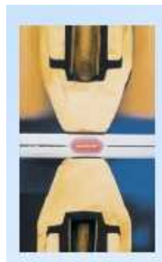
Figura 4 - Formação do ponto de solda no entre chapas num processo de Solda a Ponto (MAREK & PÖLL, 2008, modificado)
