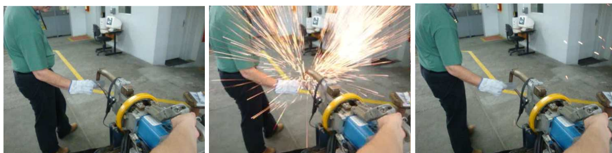
Figura 5 - Seqüência de um processo de soldagem incorreta onde ocorre expulsão de material
