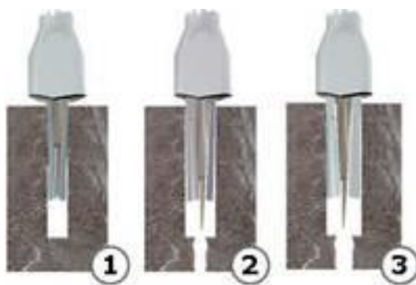
Figura 16 - Fases de execução do quebrador de cunhas
