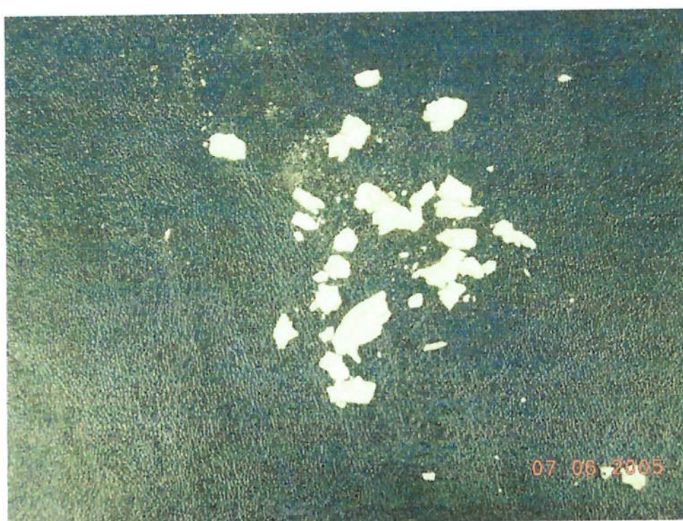
Foto 22 – Amostra dos grumos encontrados no teste 7.
