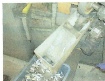
Foto 15– Peças sendo Extraídas no Polimento com Calha.
