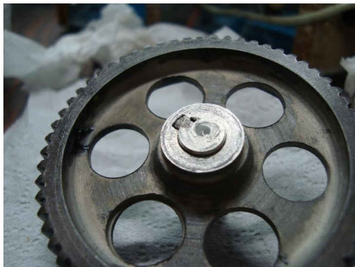
Figura 30 – Falha no eixo.
