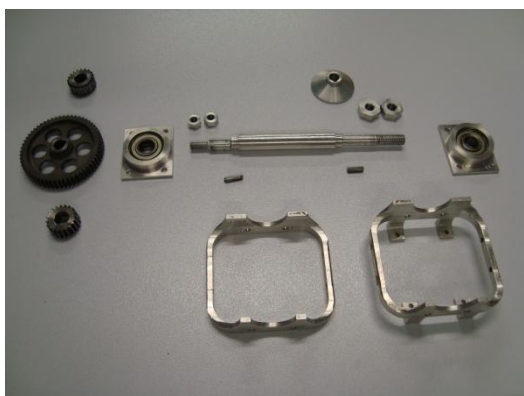
Figura 28 – Primeiro protótipo de redução desmontada.
