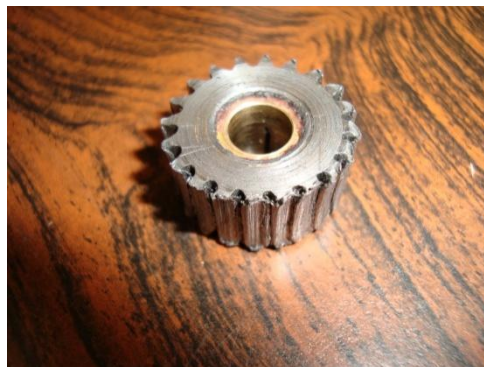
Figura 32 – Falha no pinhão.
