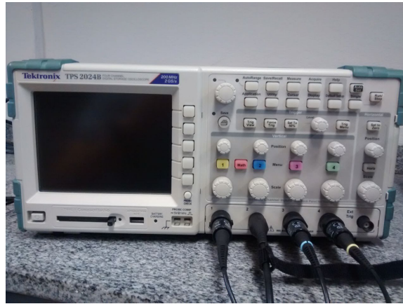
Figura 4.16: Osciloscópio para aferição da corrente e tensão gerada no tacogerador.
