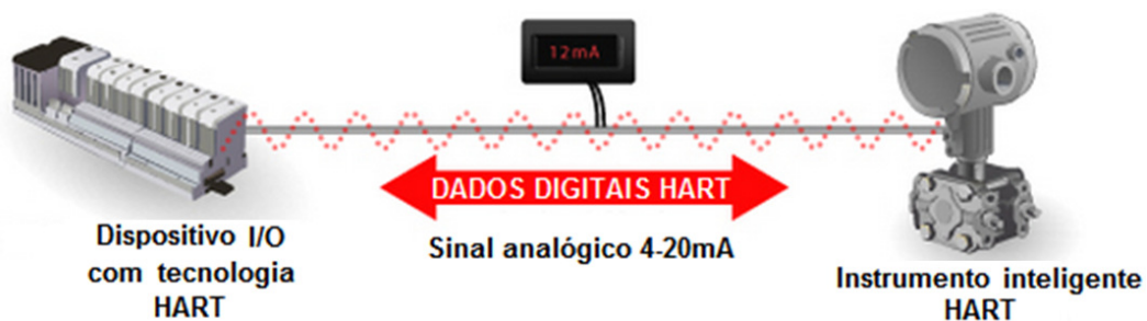
Figura 9: Os dois canais de comunicação da tecnologia HART.
