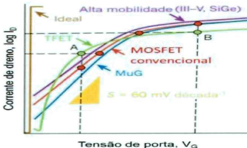
Figura 2: Comparação do tempo de transição de estado ligado/desligado para tecnologias diferentes.
