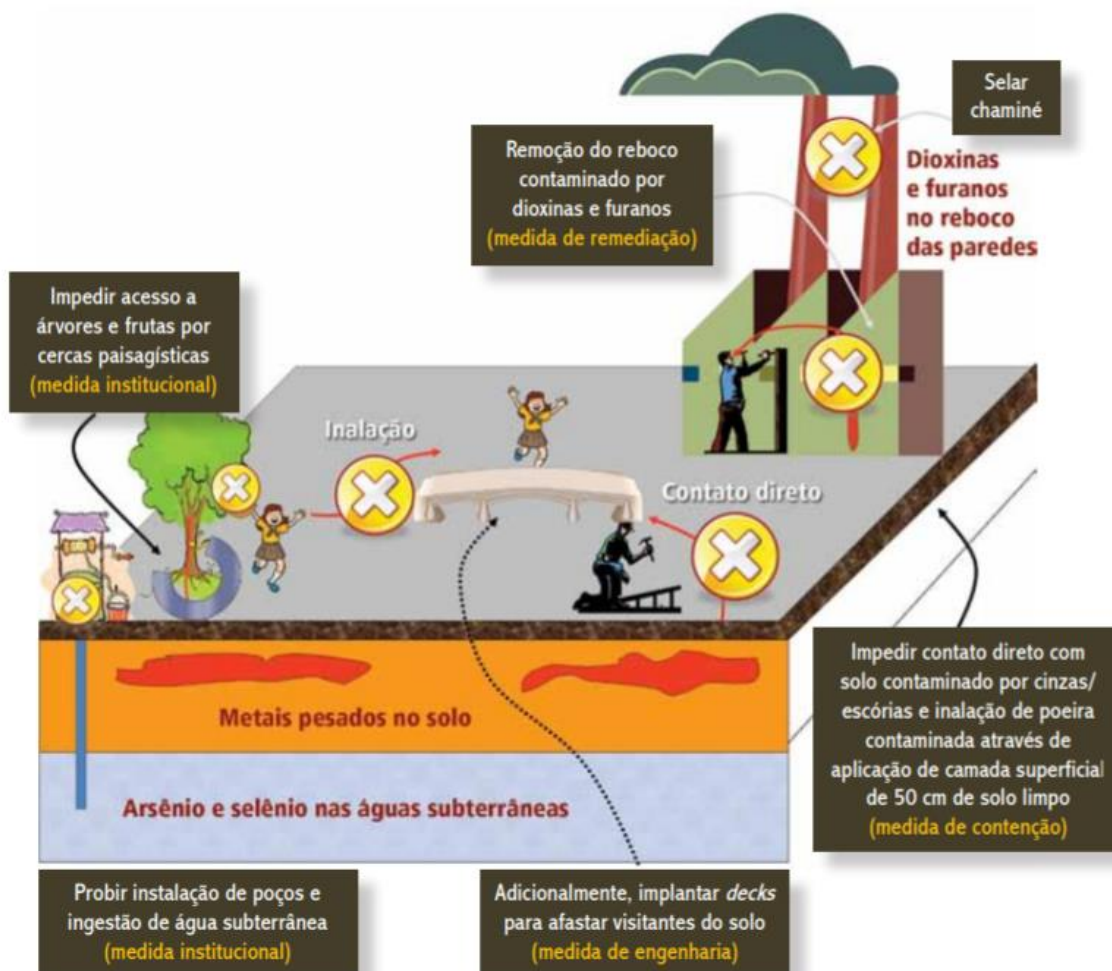
Figura 3: Modelo conceitual da área e resumo das medidas de intervenção adotadas para a reabilitação do imóvel para a mudança de uso. Fonte: Marker (2013).
