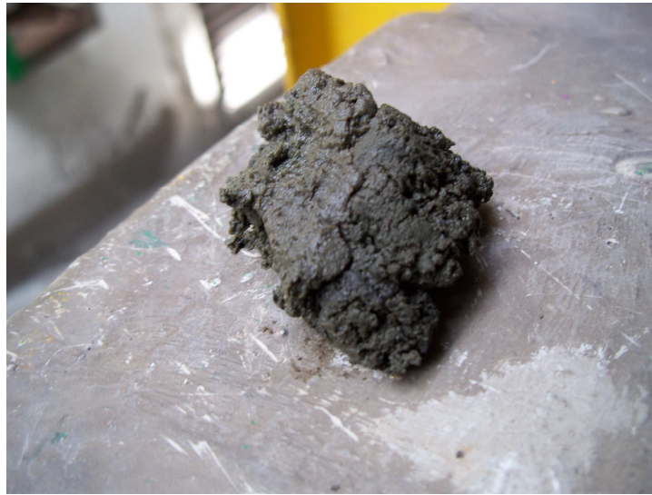
Figura 5.2 – Amostra de lodo coletada no ponto A – parede do tanque central do sistema de resfriamento
