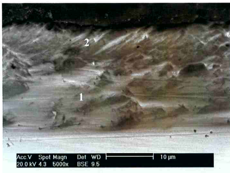
Figura 31 –Análise seccional da camada de óxido através de elétrons retroespalhados da liga Fe-12Ni-15Si após oxidação com aumento de 5000X.
