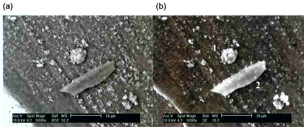
Figura 17 – Fotos tiradas no MEV através de elétrons retroespalhados (a) e elétrons secundários (b) da liga Fe-25Al-5Ti após oxidação com 5000X de aumento. No detalhe, inclusões (1) e (2) na camada de óxido.
