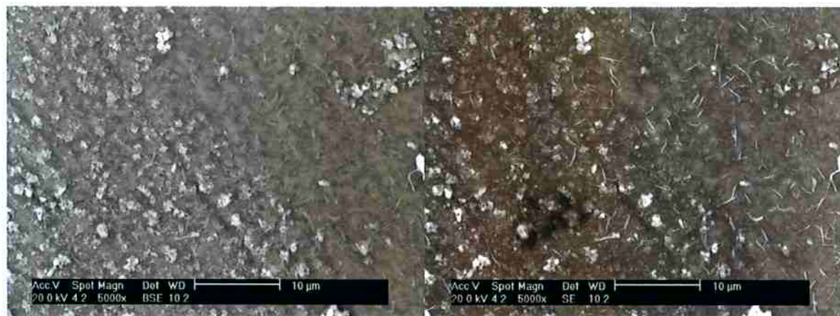
Figura 14 – Fotos tiradas no MEV através de elétrons retroespalhados (a) e elétrons secundários (b) da liga Fe-25Al-5Ti após oxidação com 5000X de aumento.
