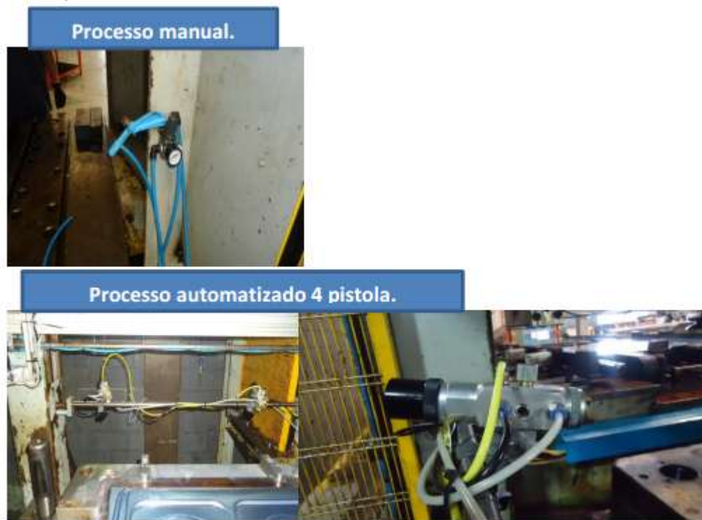
Figura 25: Processo de lubrificação da mesa de trabalho do fogão. Fonte: Autoria própria.
