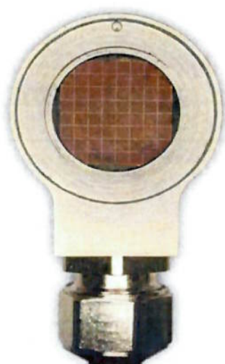
Figura 3.31 - Transdutor utilizado no equipamento de ultrassom por imagem [22].
