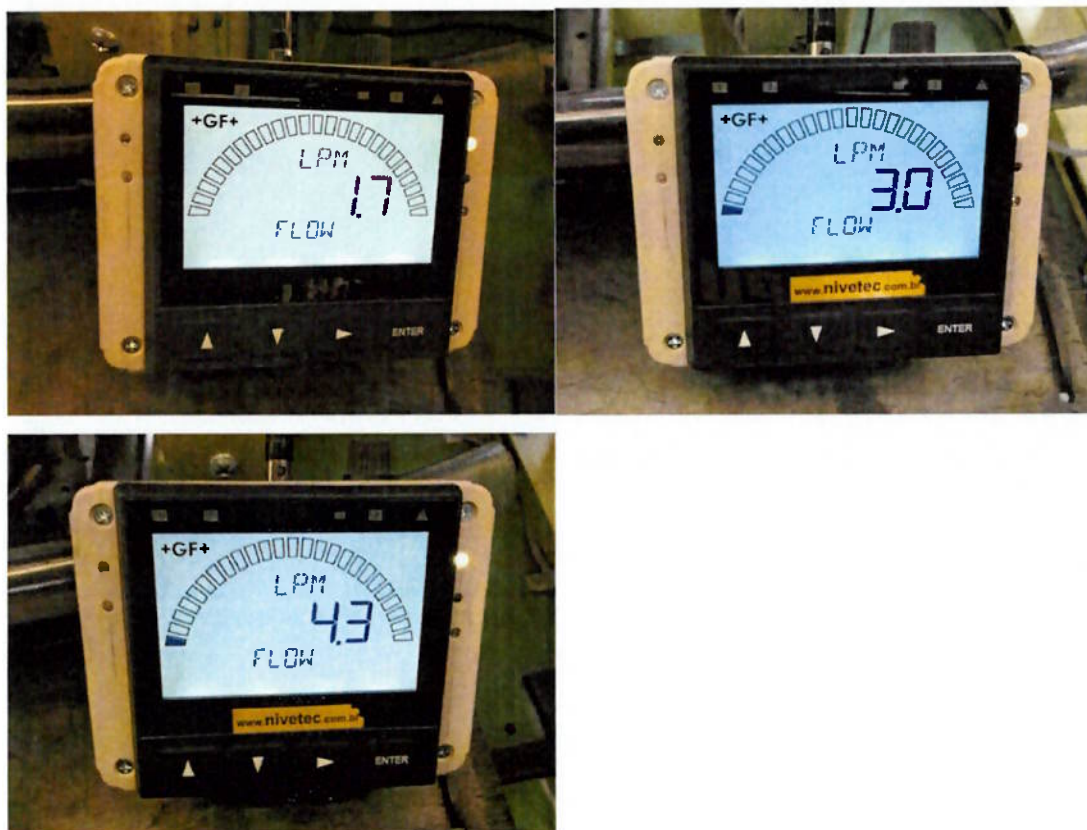
Figura 4.10 – Parâmetros de vazão de refrigeração utilizados no teste 2.
