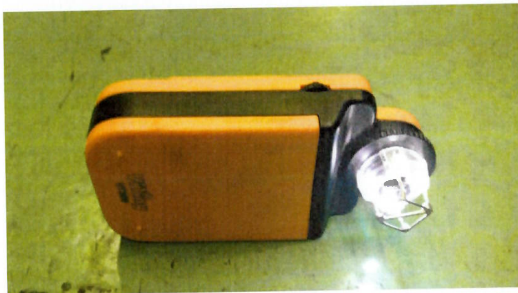
Figura 4.15 - Câmera adaptada para capturar face do eletrodo utilizado no ensaio.
