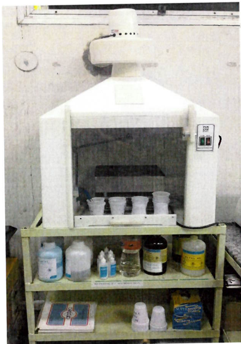
Figura 4.28 - Estufa para cura da resina do embutimento de macrografia utilizada nos ensaios.
