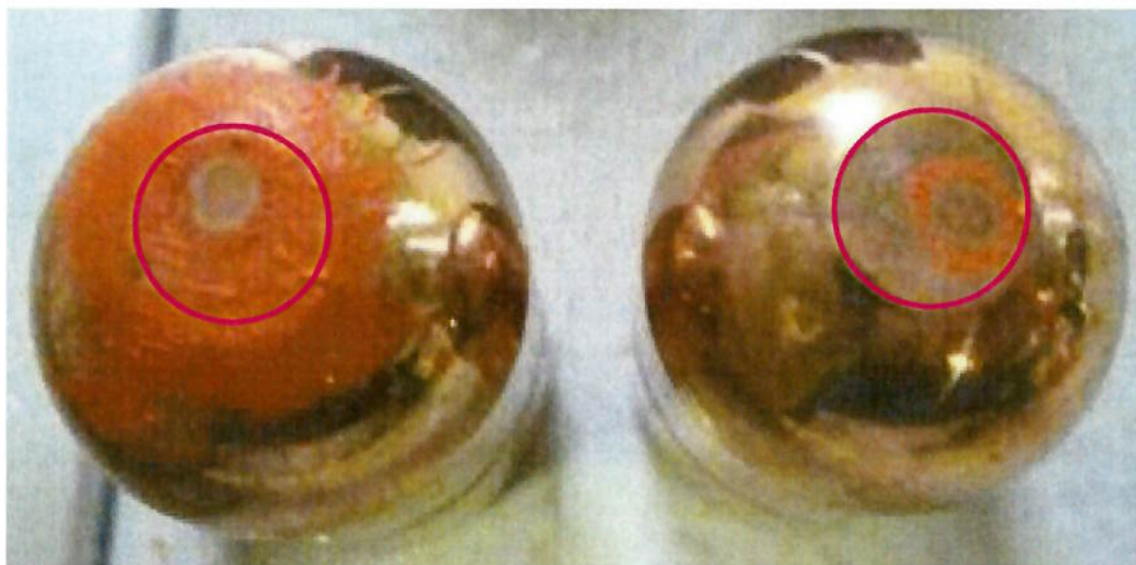
Figura.3.24 - Distribuição assimétrica da pressão.
