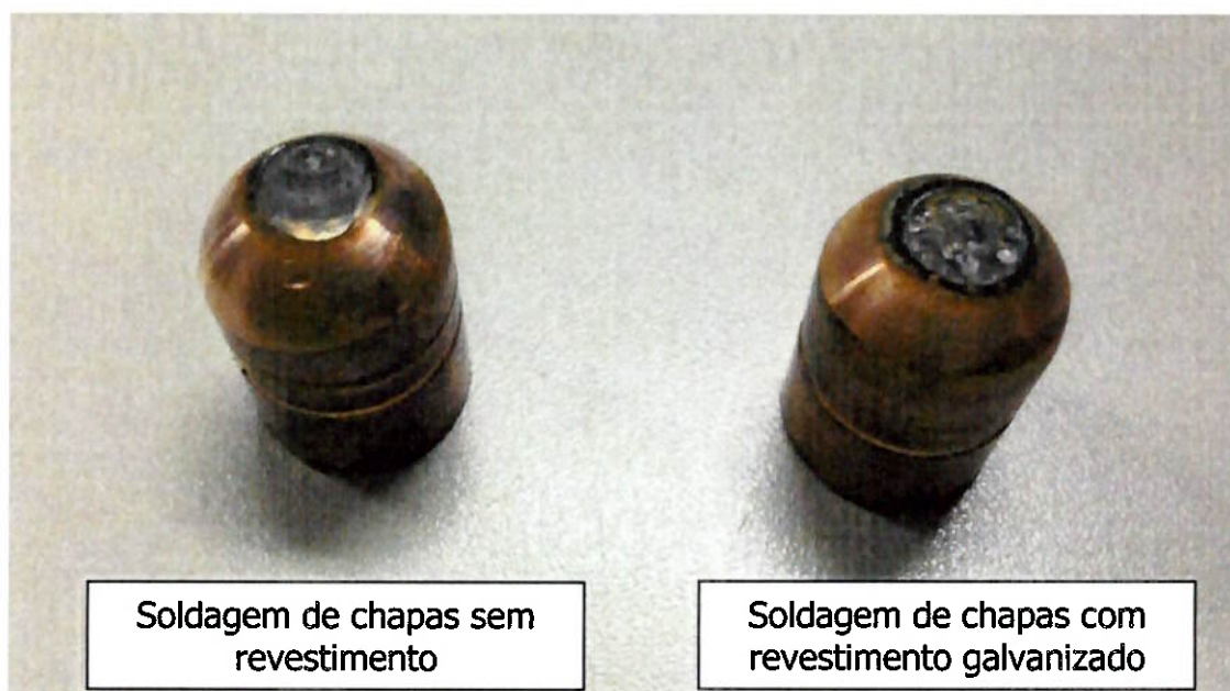
Figura 3.12 - Influência da chapa com revestimento de Zinco na vida útil do eletrodo, formação de latão na face do eletrodo.
