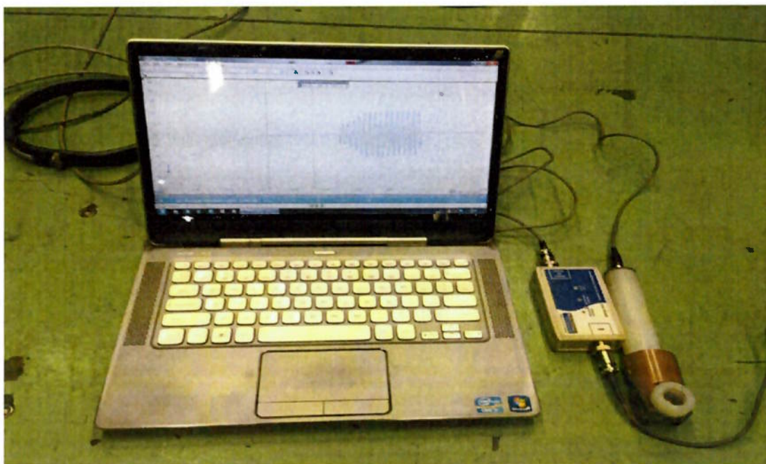
Figura 4.5 - Computador e Dinamômetro digital para a leitura da pressão e corrente de soldagem utilizado nos testes.
