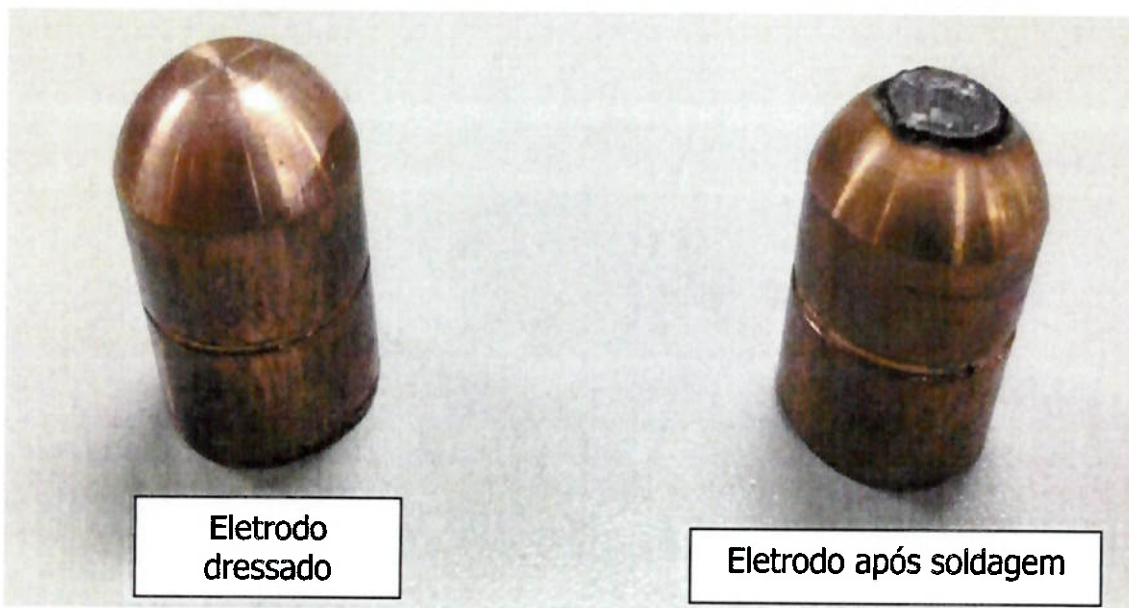
Figura 3.10 - Desgaste ou deformação do eletrodo (Vista frontal).
