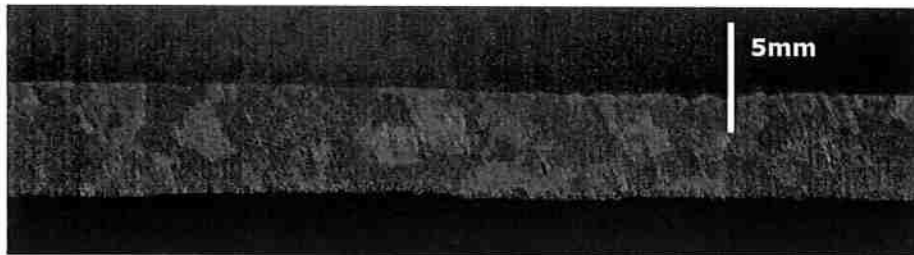
Figura 46: Amostra 3, 5mm de espessura sem coquilha, vista do plano vertical em fundo preto
