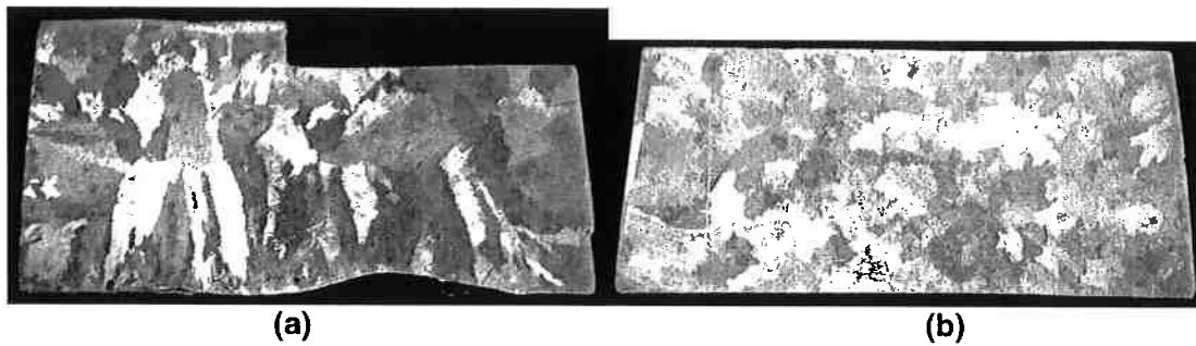
Figura 26: Macrografias da superfície (a) A (vertical) e (b) B (horizontal) da plaqueta com E=30\text{mm}
