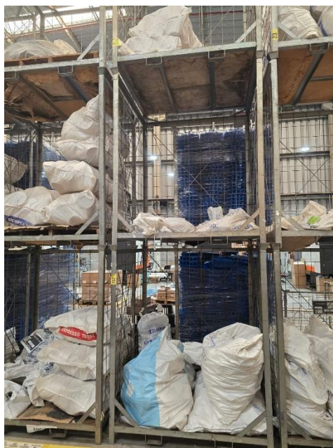
Figura 8 - Método de armazenamento em gaiolas
