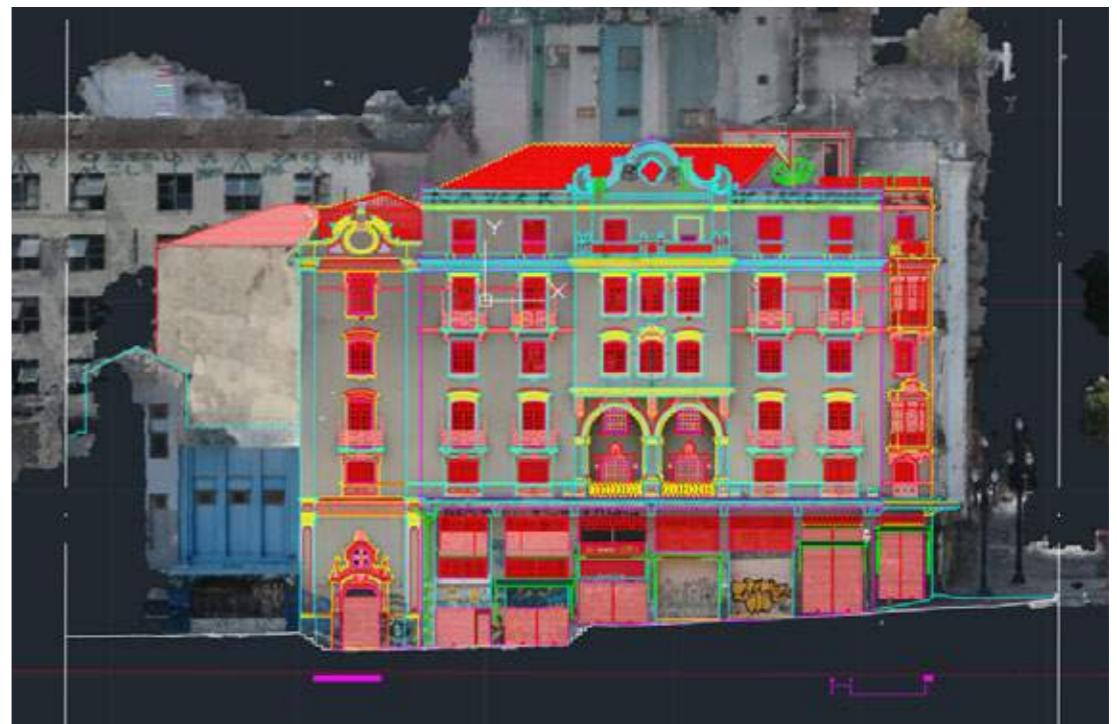
Figura 100 – Sobreposição do desenho vetorial e do ortomosaico realizado por fotogrametria, em AutoCAD.
