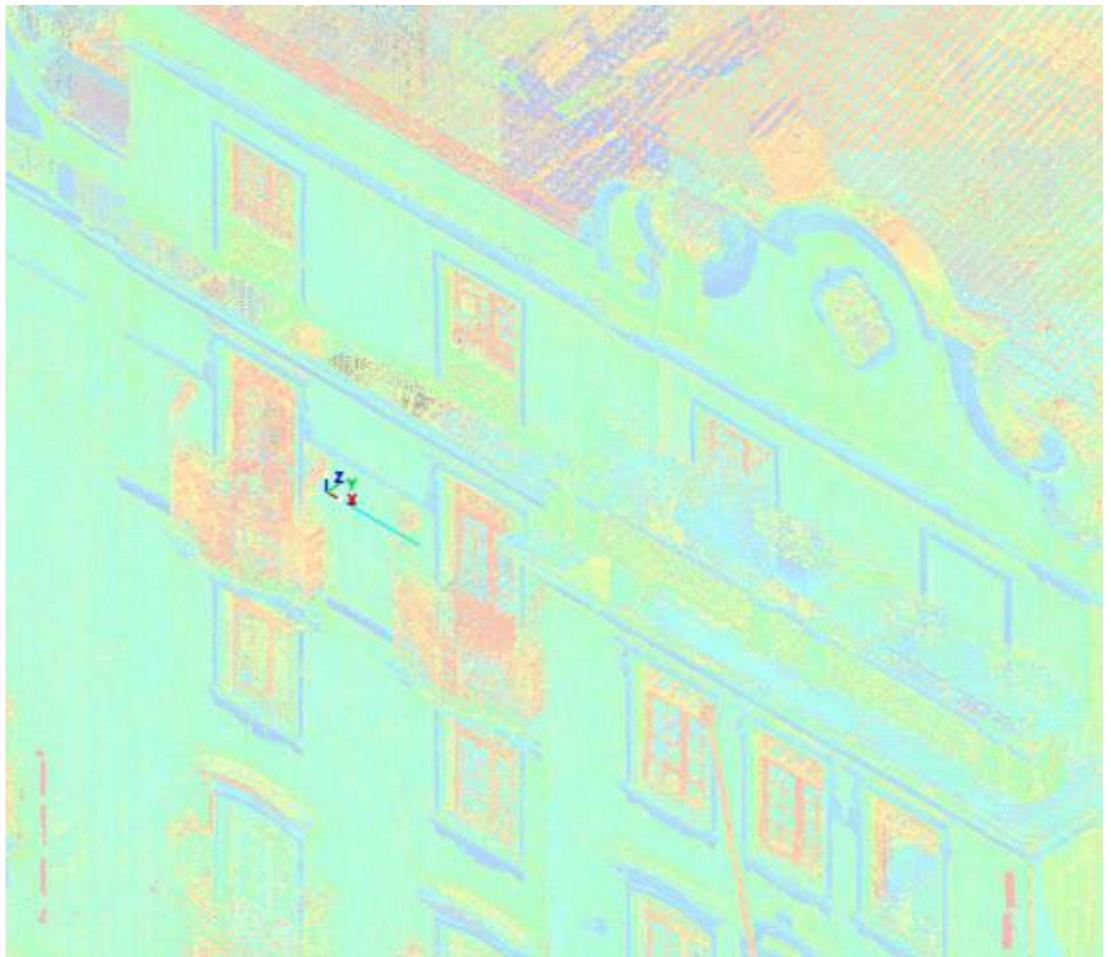
Figura 81 – Estabelecimento de um sistema de coordenadas para orientação e visualização da fachada do Vale do Anhangabaú.
