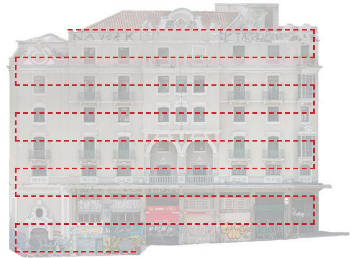
Figura 86 – Sequência linear de tomada das fotografias em serpentina.
