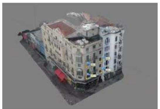
Figura 92 – Inserção dos marcadores para orientação, escalonamento e criação do ortomosaico.
