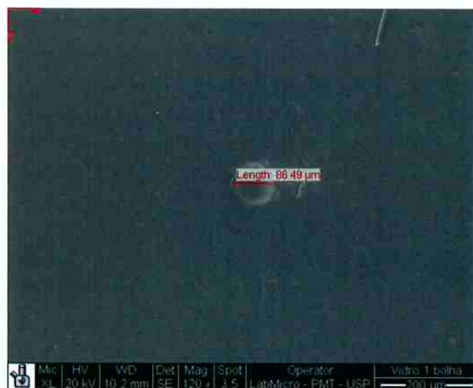
Figura 37 – Superfície da amostra de vidro 1, com o detalhe de uma bolha e seu diâmetro aproximado.
