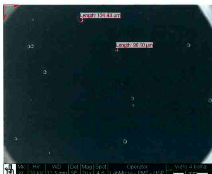
Figura 39 - Superfície da amostra 4, com os diâmetros aproximados de duas bolhas.
