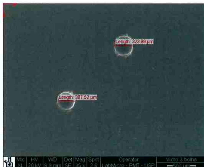
Figura 38 - Superfície da amostra de vidro 3, com o detalhe de duas bolhas e seus diâmetros aproximados.
