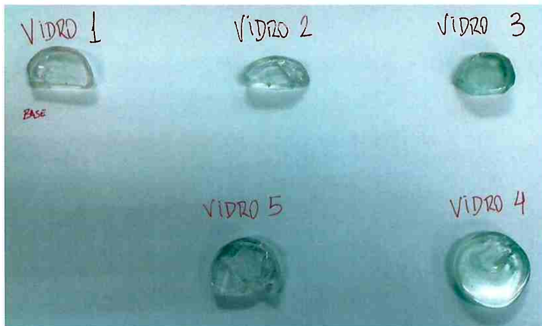
Figura 31 - Amostras utilizadas nos ensaios, após o corte, o lixamento e o polimento.
