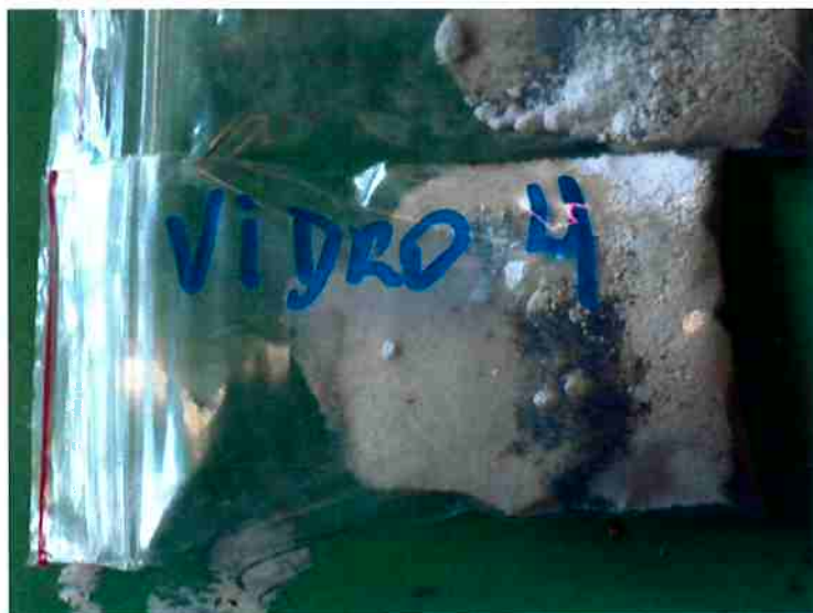
Figura 29 – Apresentação no detalhe dos componentes da amostra de vidro 4. Mais a esquerda, a areia ( \text{SiO}_2 ), o pó cinza mais escuro é o calcário ( \text{CaCO}_3 ), o branco, a barrilha ( \text{Na}_2\text{CO}_3 ) e, a direita, a CBC peneirada.
