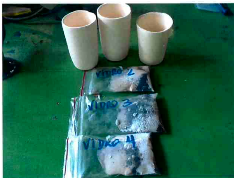
Figura 28 – Matérias-primas em pó utilizadas para a composição dos vidros 2, 3 e 4 e os cadinhos refratários de alumina que foram utilizados na fusão
