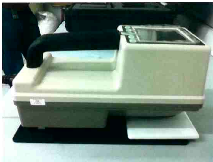
Figura 24 - Colorímetro utilizado na determinação da cor das amostras de vidro
