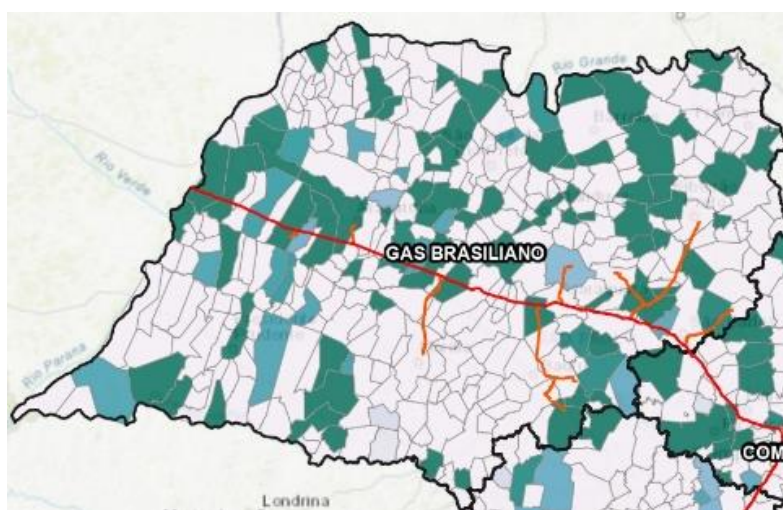
Figura 14 - Comparativo entre rede instalada pela Gás Brasileiro e potencial de biogás/biometano produzido por fonte: resíduos sucroenergéticos
