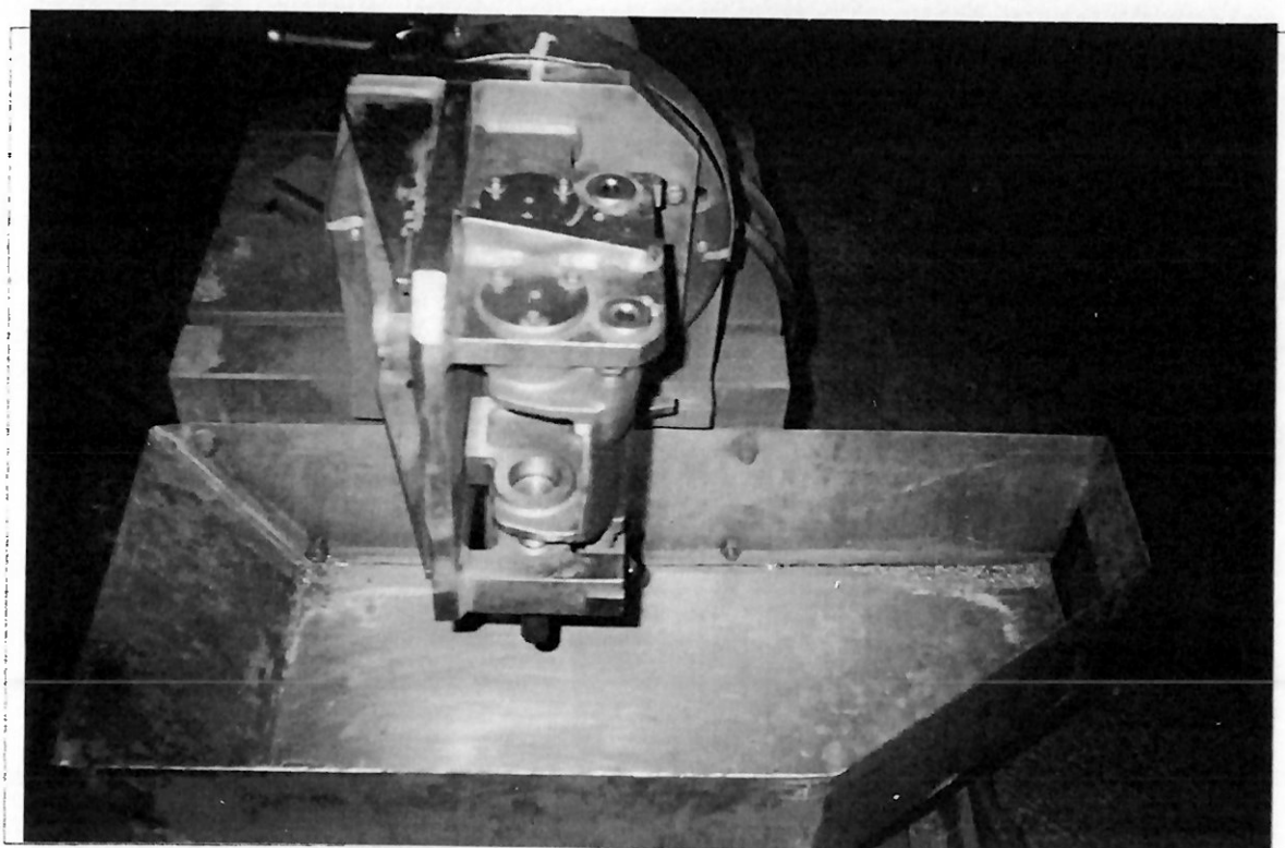
Fotografia 5.1- Dispositivo de Fixação com Gabarito para Furos (Máquina 513 - Furadeira Radial GSP)
