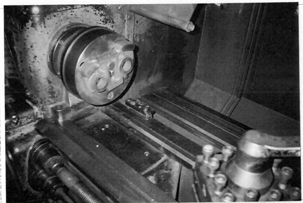
Fotografia 6.2- Peça fixada - Máquina 023 - Tomo Tovaglieri
