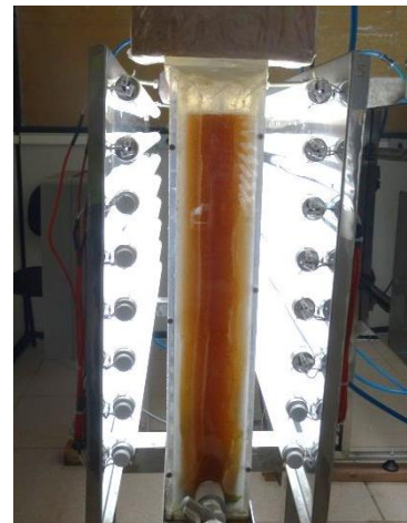
Figura 22 - Primeira unidade do FBRC 2 após 10 dias de cultivo e em detalhe a espuma formada no topo do reator.
