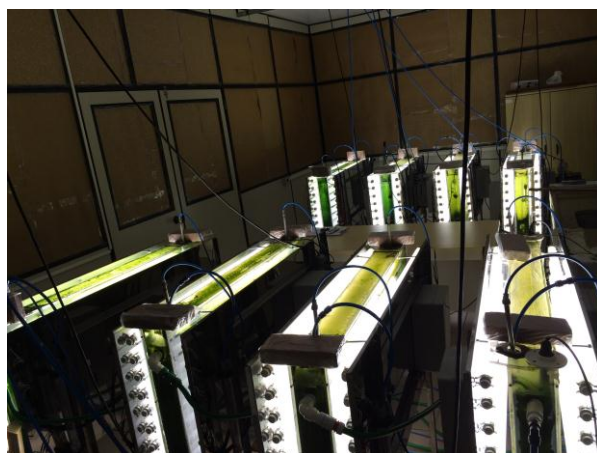
Figura 5 - Vista geral da sala com os dois sistemas de fotobiorreatores, com as janelas revestidas para que não entrasse luz solar.
