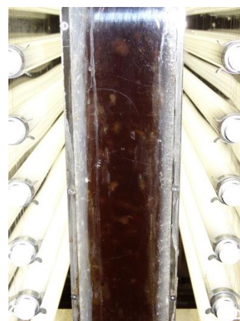
Figura 20 - Foto após 10 dias de cultivo com destaque da primeira unidade do FBRC 1 e presença de fungos.
