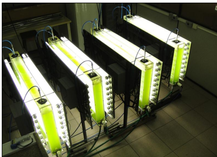
Figura 4 - Sistema FBRC 1 em operação com Chlorella vulgaris , contendo as unidades 4, 3, 2, 1 da esquerda para a direita.
