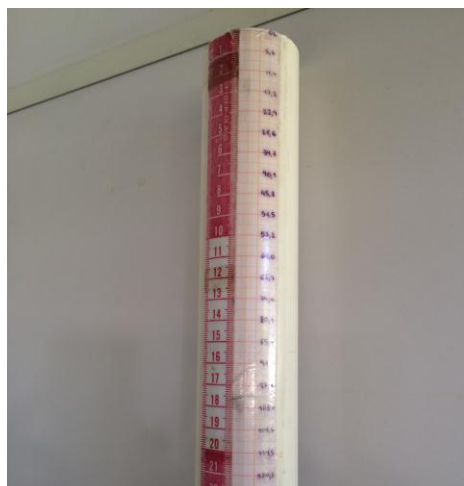
Figura 10. Em (a) e (b) imagens da régua utilizada para determinação do volume de meio nos reservatórios de alimentação.
