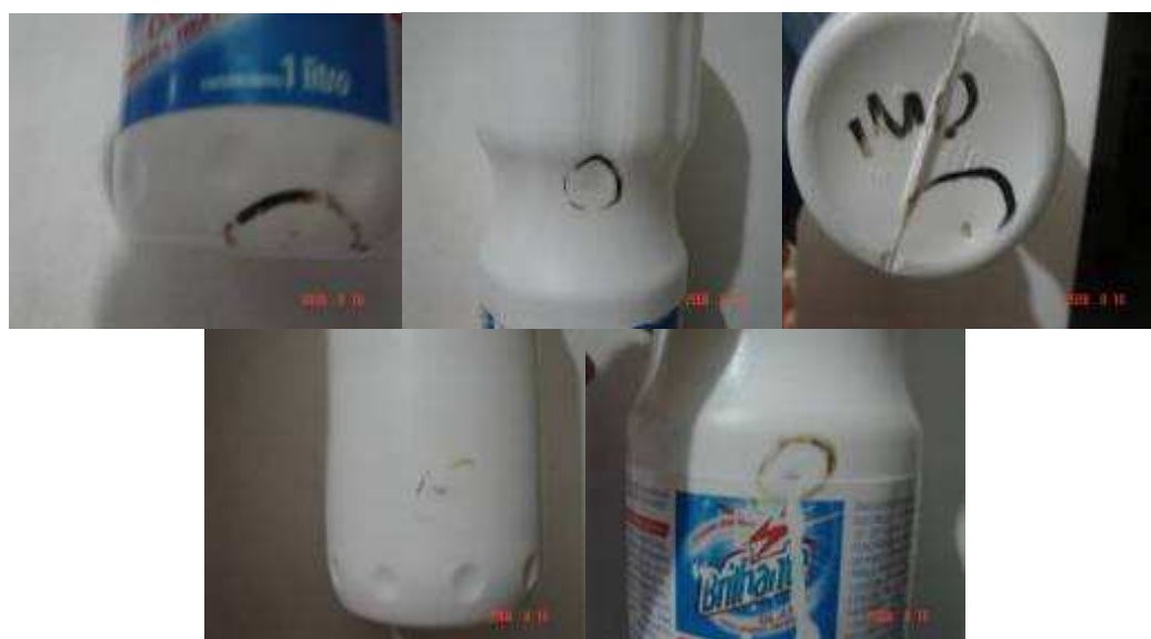
FIGURA 19: GARRAFAS DE 1 LITRO ENCONTRADAS NO CD COM PROBLEMAS DE VAZAMENTO (PRESENÇA DE IMPUREZAS INCRUSTADAS COM “MICROFUROS”
