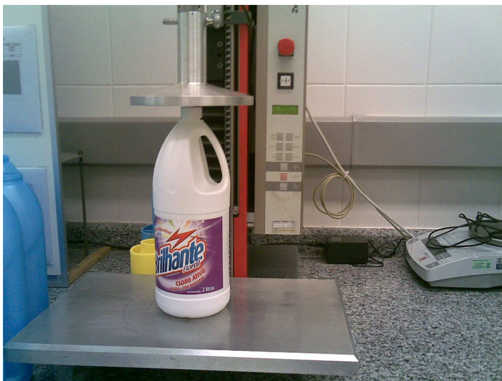
FIGURA 40 : EQUIPAMENTO PARA TESTE DE COMPRESSÃO DA MARCA ZWICK
